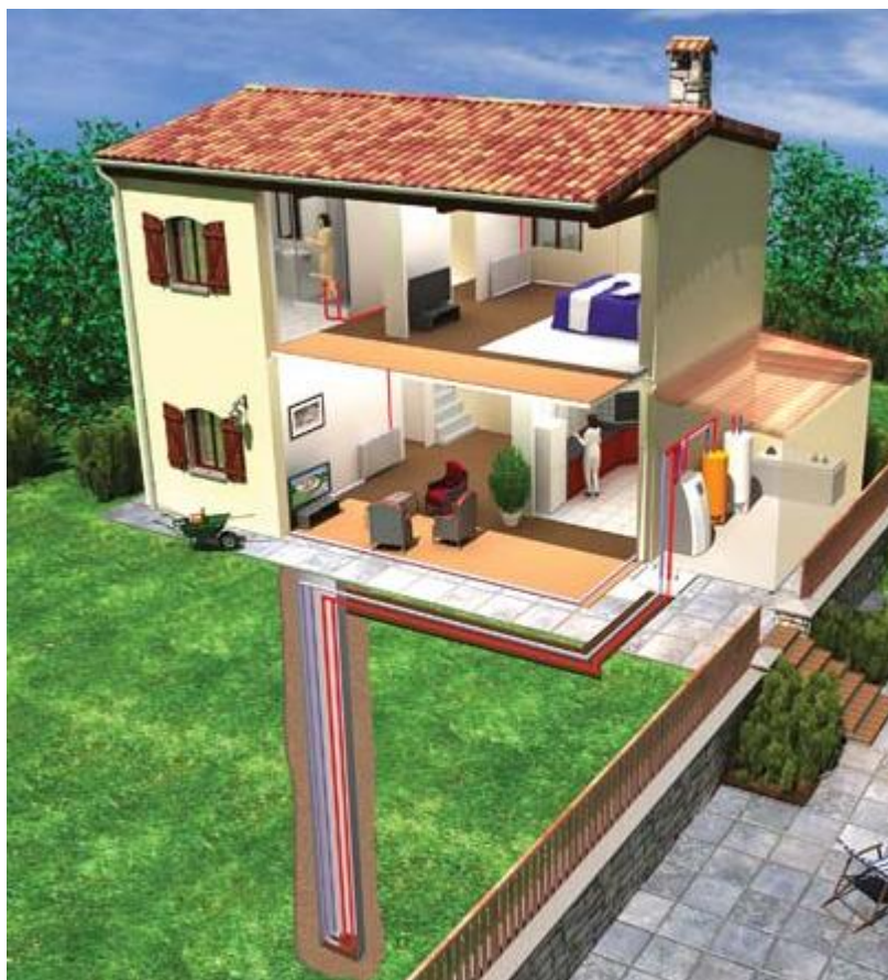
Σχήμα 1.1 : Παράδειγμα εφαρμογής αβαθής γεωθερμίας σε μονοκατοικία
