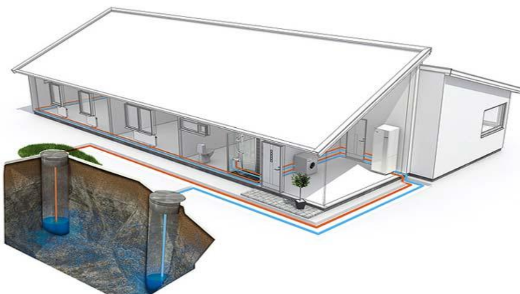
Σχήμα 1.8 : Εικόνα ενός ανοιχτού κυκλώματος , δείχνει έναν σωλήνα να μεταφέρει νερό από το σπίτι προς τα έξω, μέσα στο έδαφος, και από κει σε ένα πηγάδι, όπου αδειάζεται στο νερό του εδάφους. Ένας ξεχωριστός σωλήνας μέσα σε πηγάδι λίγο πιο πέρα αντλεί νερό από το πηγάδι και το επιστρέφει στο σπίτι.
