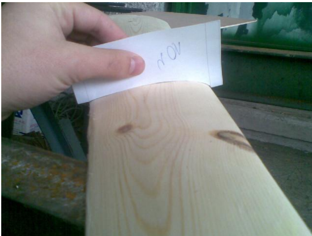
Εικόνα 11.3.15 Έλεγχος της καμπυλότητας στον εκάστοτε σταθμό με τα διαγράμματα.
