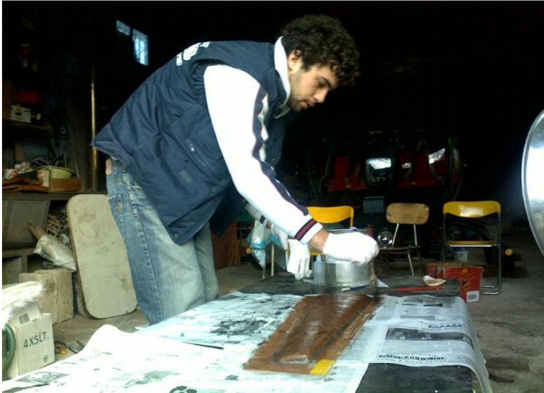
Εικόνα 11.4.2.3: Κατασκευή καλουπιού. Τελικό πέρασμα με πολυεστέρα.
