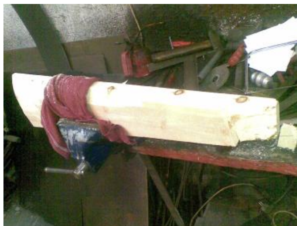
Εικόνα 11.3.5: Αφαίρεση κομματιών με το ξυλοπρίονο.
