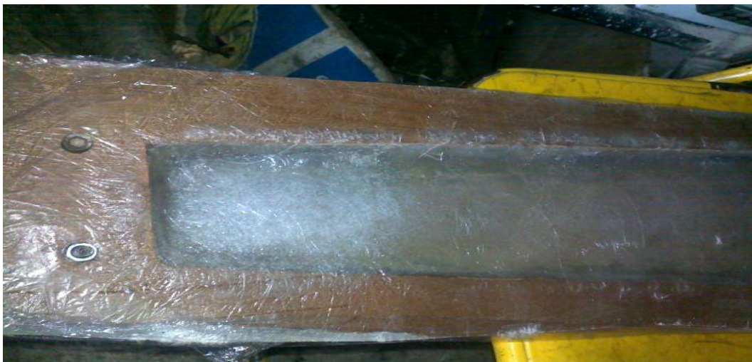
Εικόνα 11.5.6: Κοχλίες για ένωση των καλουπιών
