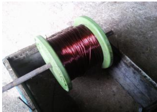
Εικόνα 12.2.9.1: Σύρμα περιέλιξης 1,7mm στο καρούλι.
