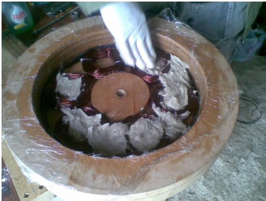
Σχήμα 12.2.9.8: Τοποθέτηση μίγματος πολυεστέρα-πούδρας.
