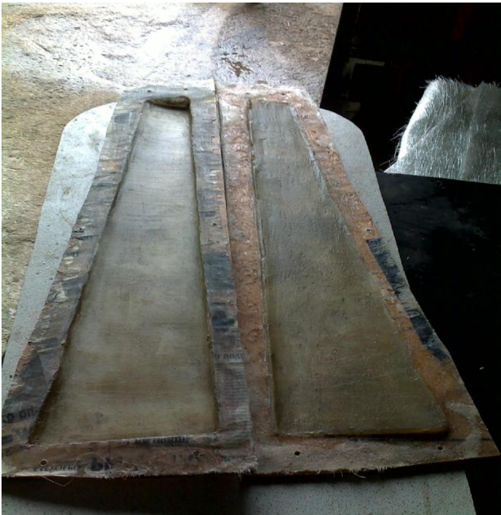
Εικόνα 11.4.3.6: Τα δύο καλούπια ολοκληρωμένα.
