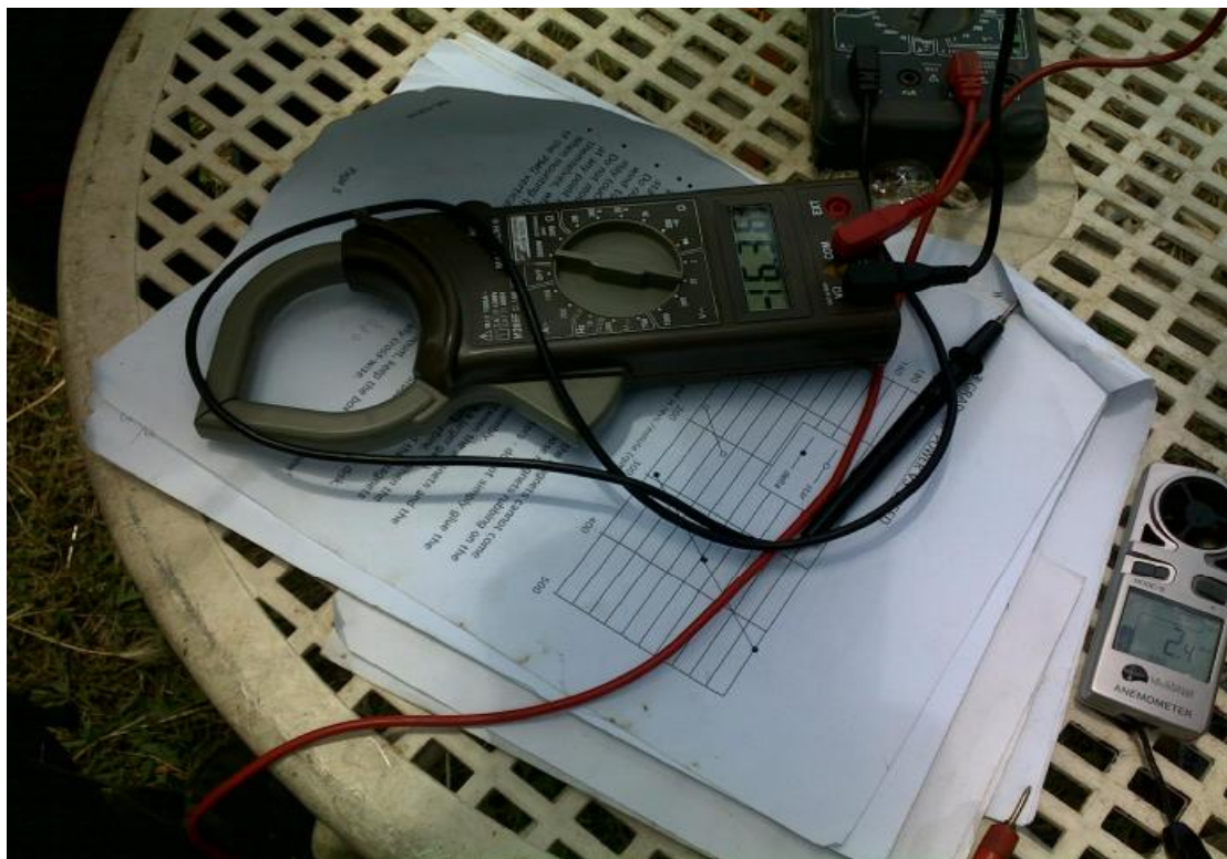
Εικόνα 14.2.2: Πολύμετρα για μέτρηση Amperes- Volts σε λειτουργία
