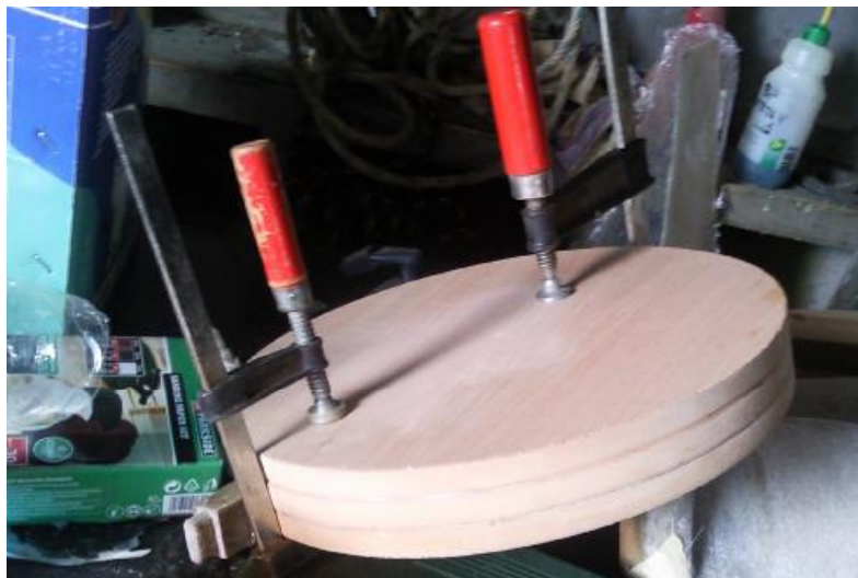
Εικόνα 12.2.4.1: Φαίνονται οι τρεις δίσκοι όπου απαρτίζουν το εσωτερικό καλούπι. Τοποθετήθηκε κόλλα ξύλου και δέθηκαν με σφικτήρες.
