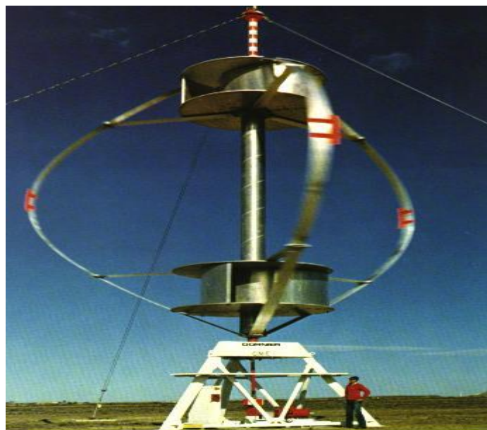
Σχήμα 6.9.2.3: Συνδυασμένη λειτουργία Savonius-Darrieus Πηγή : Google-Images
