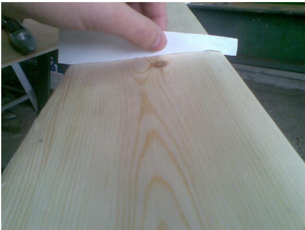
Εικόνα 11.3.16: Έλεγχος της καμπυλότητας στον εκάστοτε σταθμό με τα διαγράμματα.
