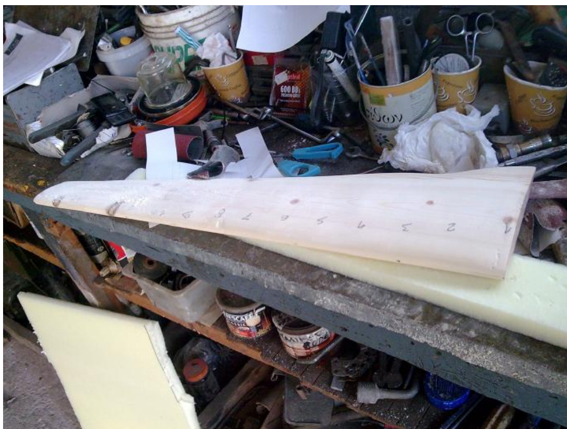
Εικόνα 11.3.17: Στάδιο φινιρίσματος με σμυριδόπανο.
