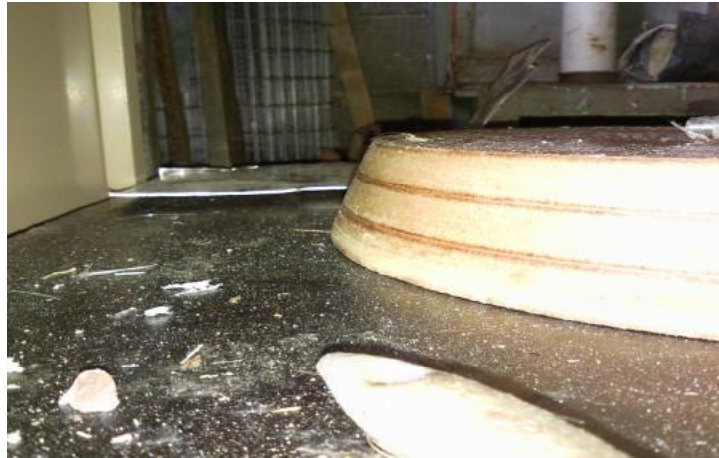
Εικόνα 12.2.4.3: Όψη τελειωμένου εσωτερικού καλουπιού. Έπειτα ελέγχθηκε αν το εσωτερικό καλούπι εφαρμόζει στο εξωτερικό και αν υπάρχει ένα διάκενο τουλάχιστον 5 mm μεταξύ τους.
