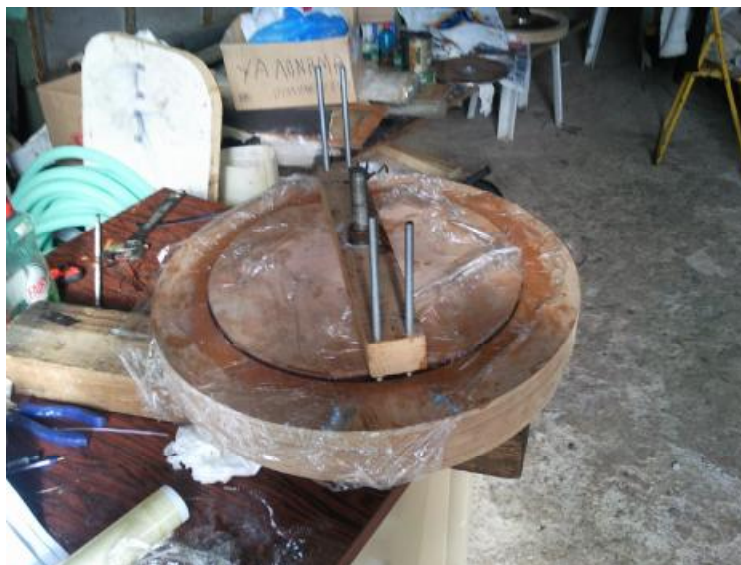
Εικόνα 12.2.9.11: Τοποθέτηση του εσωτερικού καλουπιού μέσα στο εξωτερικό και σύσφιξη όλων μαζί.
