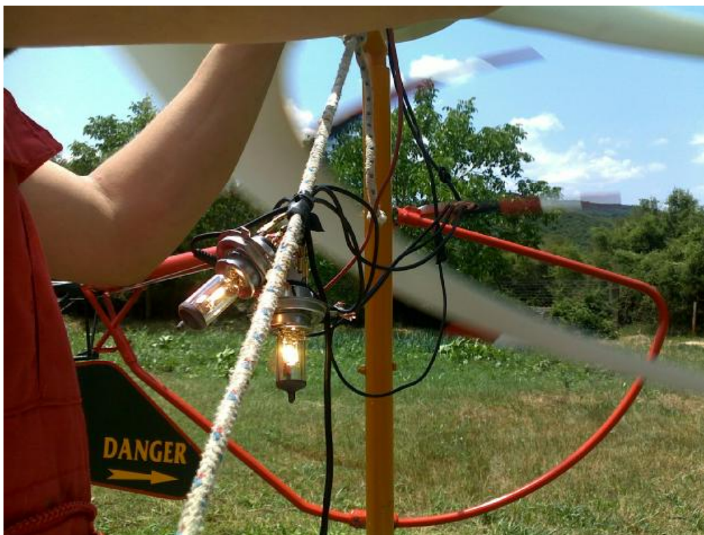
Εικόνα 14.2.5: Φορτίο 230 Watts αποτελούμενο από λαμπτήρες αυτοκινήτου.
