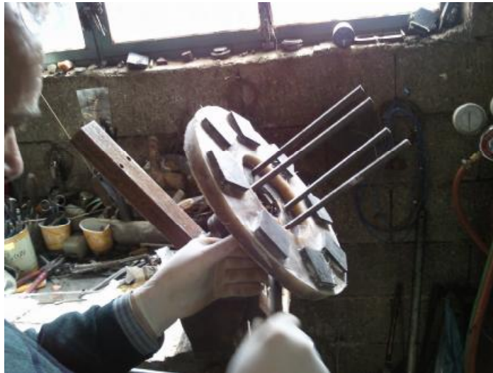
Εικόνα 12.2.12.1: Προσαρμογή του πίσω δρομέα στο σύνδεσμο
