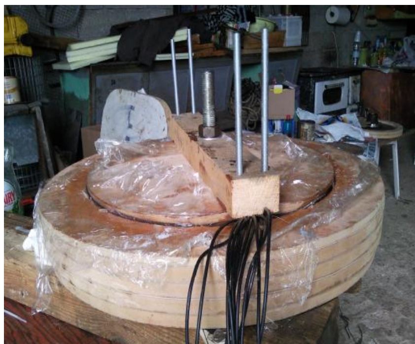
Εικόνα 12.2.9.12: Δέσμη καλωδίων στάτη.
