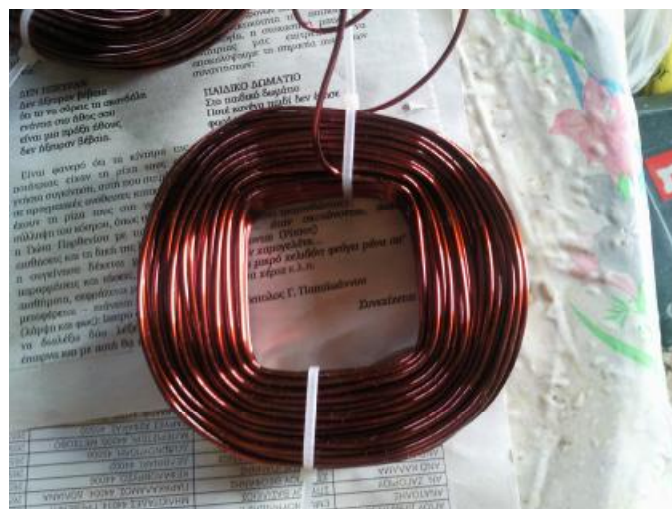
Εικόνα 12.2.9.3: Διακρίνεται το δεματικό το οποίο συγκρατεί σφιχτά το τύλιγμα
