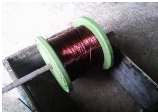
Εικόνα 12.2.1: Σύρμα περιέλιξης 1,7mm στο καρούλι.
