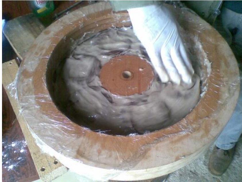
Σχήμα 12.2.9.9: Τοποθέτηση μίγματος πολυεστέρα-πούδρας.
