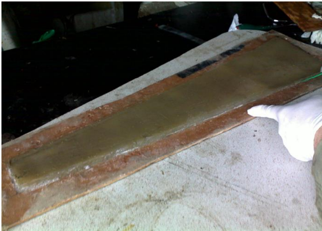
Εικόνα 11.4.3.4: Τελική μορφή, μετά το στοκάρισμα
