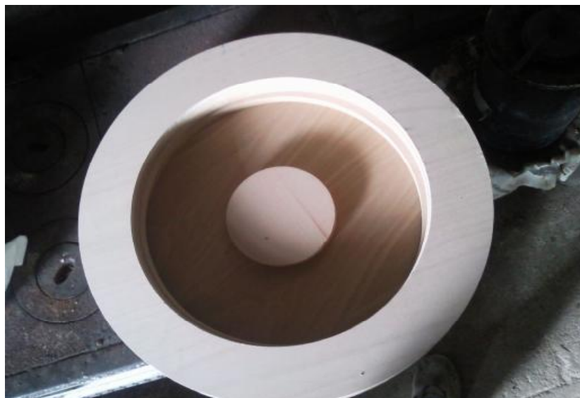
Εικόνα 12.2.3.2: Τοποθέτηση και κεντράρισμα των κομματιών πριν κολληθούν και τρυπηθούν.
