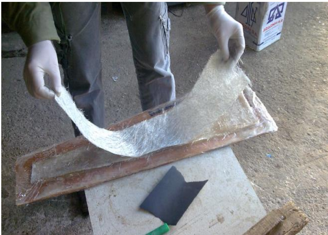
Σχήμα 11.5.2: Διακρίνεται η μεμβράνη και η πρώτη στρώση υαλόπανου
