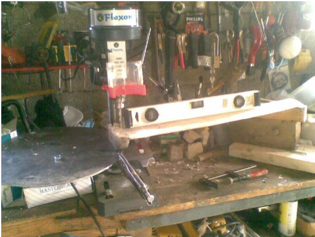
Εικόνα 11.8.3: Οριζοντίωση πτερυγίου με τους μεταλλικούς δίσκους
