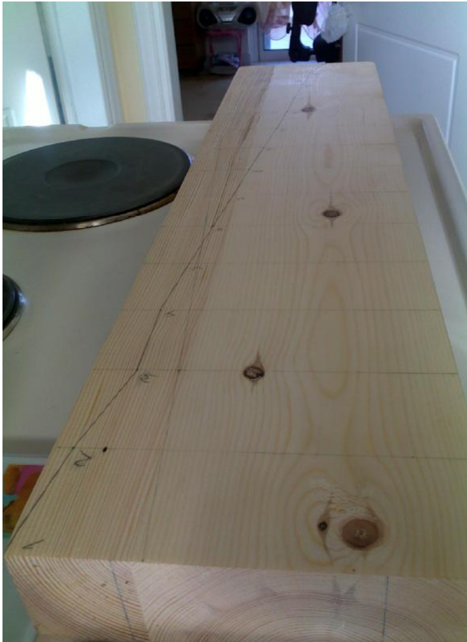
Εικόνα 11.3.4: Σχεδίαση σταθμών και χάραξη κάθε χορδής των αεροτομών.
