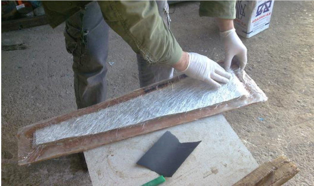
Εικόνα 11.5.3: Τοποθέτηση του υαλόπανου μέσα στο καλούπι
