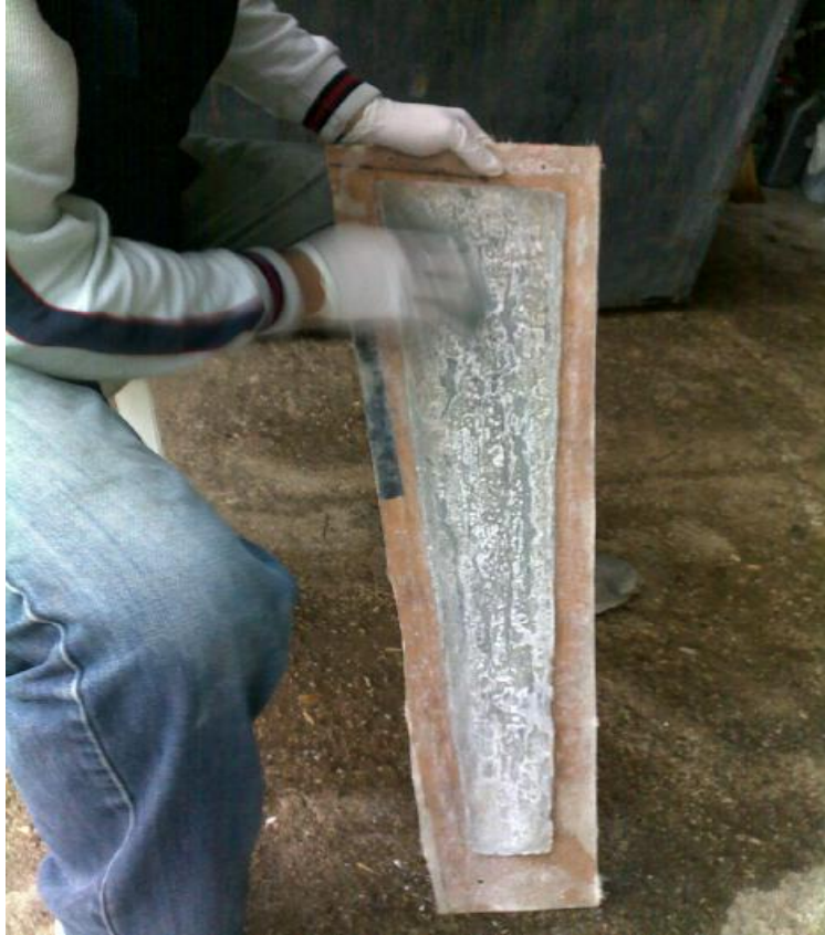
Εικόνα 11.4.3.1: Τρίψιμο με σμυριδόπανο για εξάλειψη των ατελειών.
