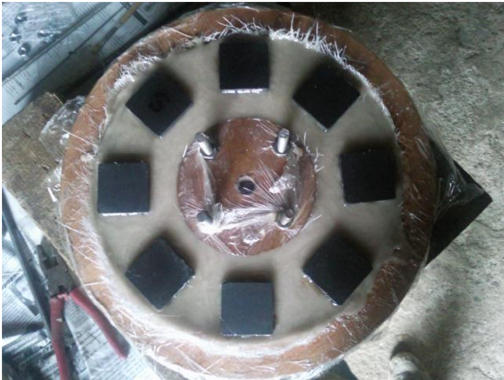
Εικόνα 12.2.10.5: Ολοκλήρωση δρομέα στο καλούπι.
