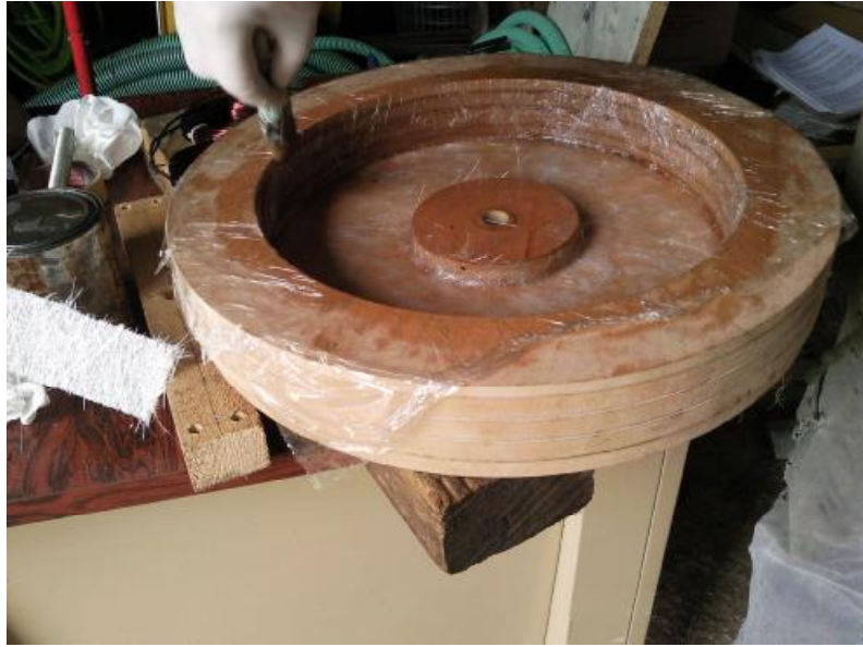
Εικόνα 12.2.9.4: Τοποθέτηση αντικολλητικού και μεμβράνης στο εξωτερικό καλούπι
