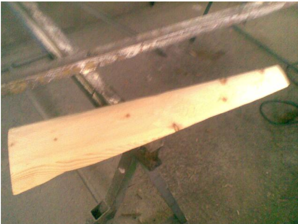
Εικόνα 11.3.13: Άποψη πρότυπης πτέρυγας κατά την κατασκευή
