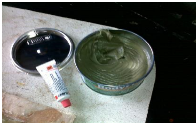
Εικόνα 11.4.3.2: Στόκος πολυεστέρα και σκληρυντής.
