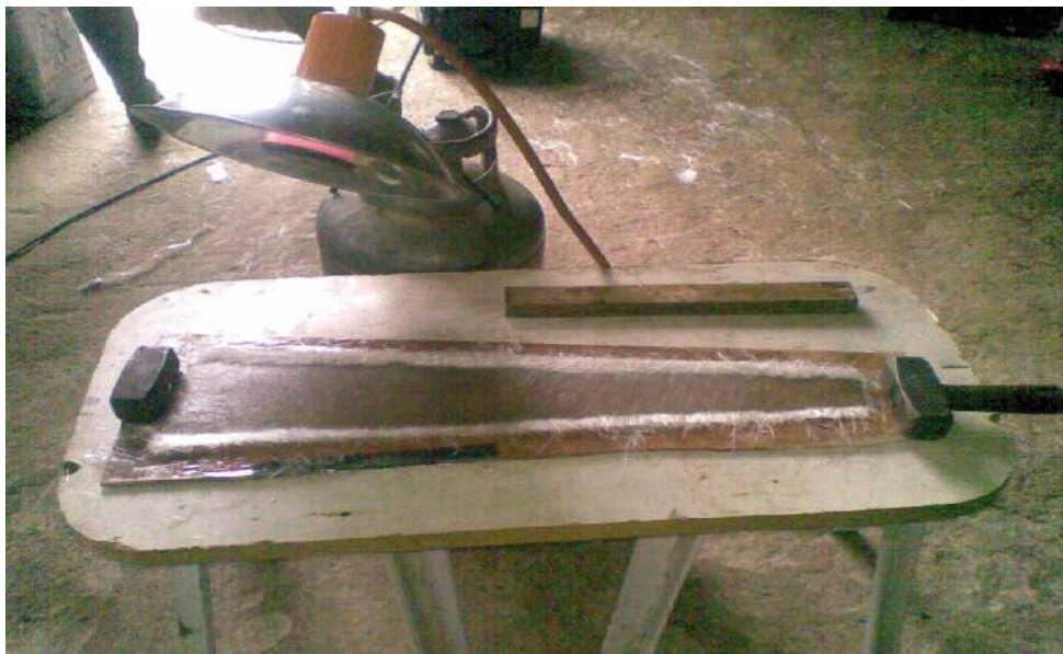
Εικόνα 11.5.4: Βεβιασμένο στέγνωμα του πολυεστέρα
