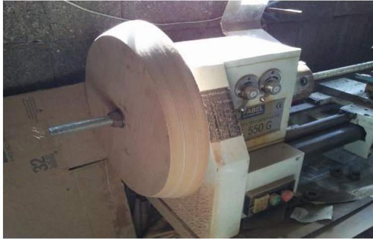
Εικόνα 12.2.4.2: Εσωτερικό καλούπι πάνω στο τόρνο και κλίση 20^\circ που έχει δημιουργηθεί.
