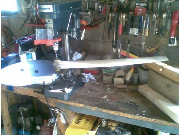
Εικόνα 11.8.1: Άνοιγμα οπών στις βάσεις των πτερυγίων.
