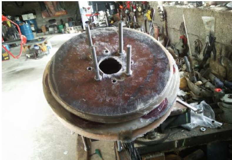
Εικόνα 12.2.12.3 Τοποθέτηση του μπροστά δρομέα στο στάτη
