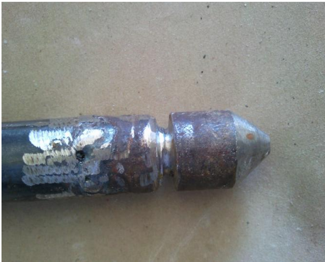
Εικόνα 11.7.4: Μηχανισμός με πείρο που επιτρέπει την περιστροφή της Α/Γ γύρο από τον άξονα της αλλά αποτρέπει την εξαγωγή της προς τα επάνω σε περίπτωση ισχυρών ανέμων.
