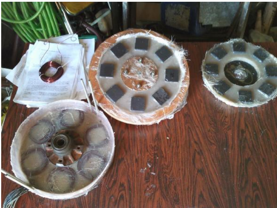
Σχήμα 12.2.10.7: Ολοκληρωμένος δρομέας και στάτης και δρομέας στο καλούπι.
