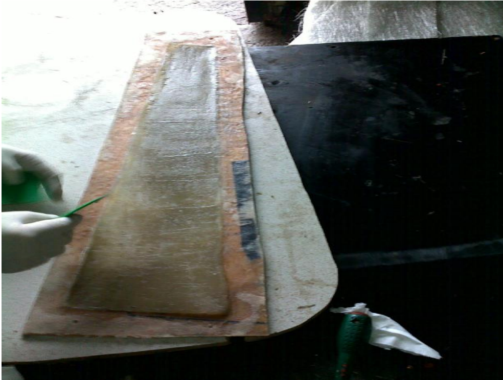
Εικόνα 11.4.3.3: Στοκάρισμα για τελειοποίηση του καλουπιού
