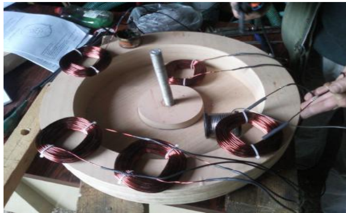
Σχήμα 12.2.8.1: Έλεγχος εφαρμογής των τυλιγμάτων στο καλούπι
