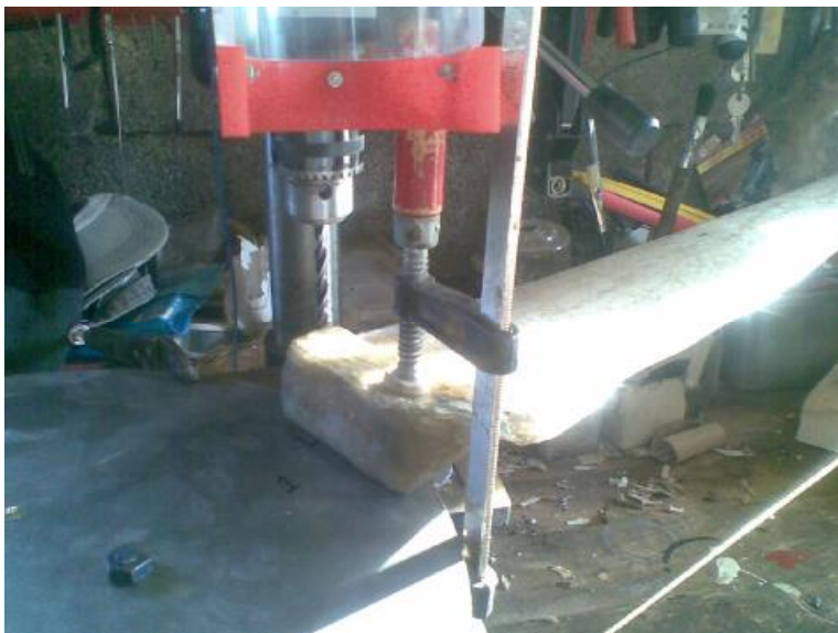
Εικόνα 11.8.2: Άνοιγμα οπών στις βάσεις των πτερυγίων.
