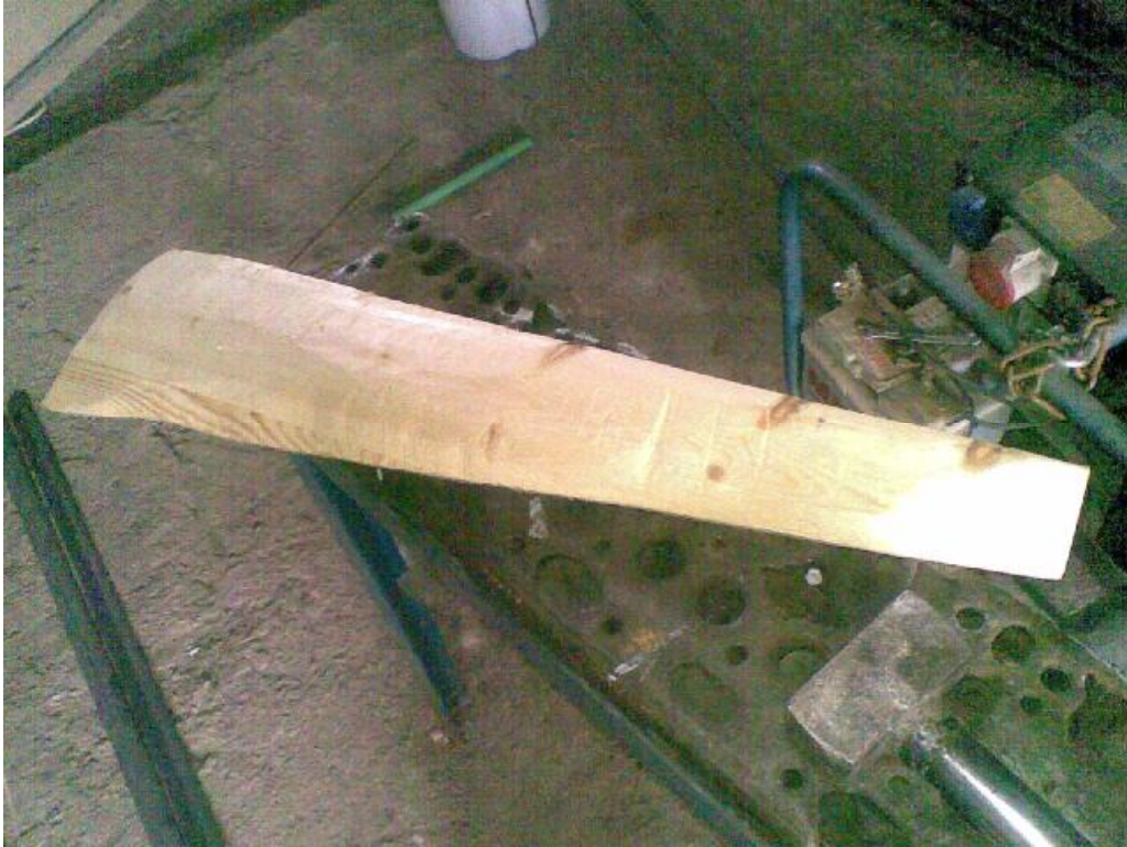
Εικόνα 11.3.10: Άποψη πρότυπης πτέρυγας κατά την κατασκευή
