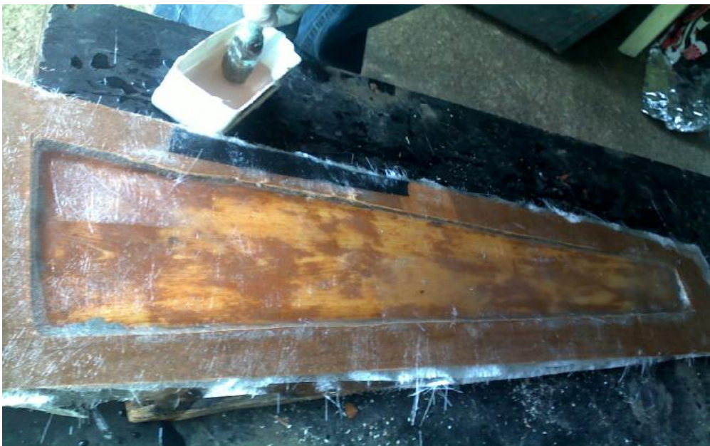
Εικόνα 11.4.2.7 Νωπό τελειωμένο καλούπι.
