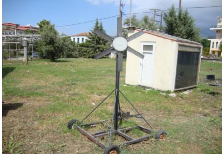
Εικόνα 2.2.1.2: Πολύπτερη Α/Γ οριζόντιου άξονα με δυνατότητα μετακίνησης Πηγή: Εργαστήριο Η.Μ.Ε Πάτρα
