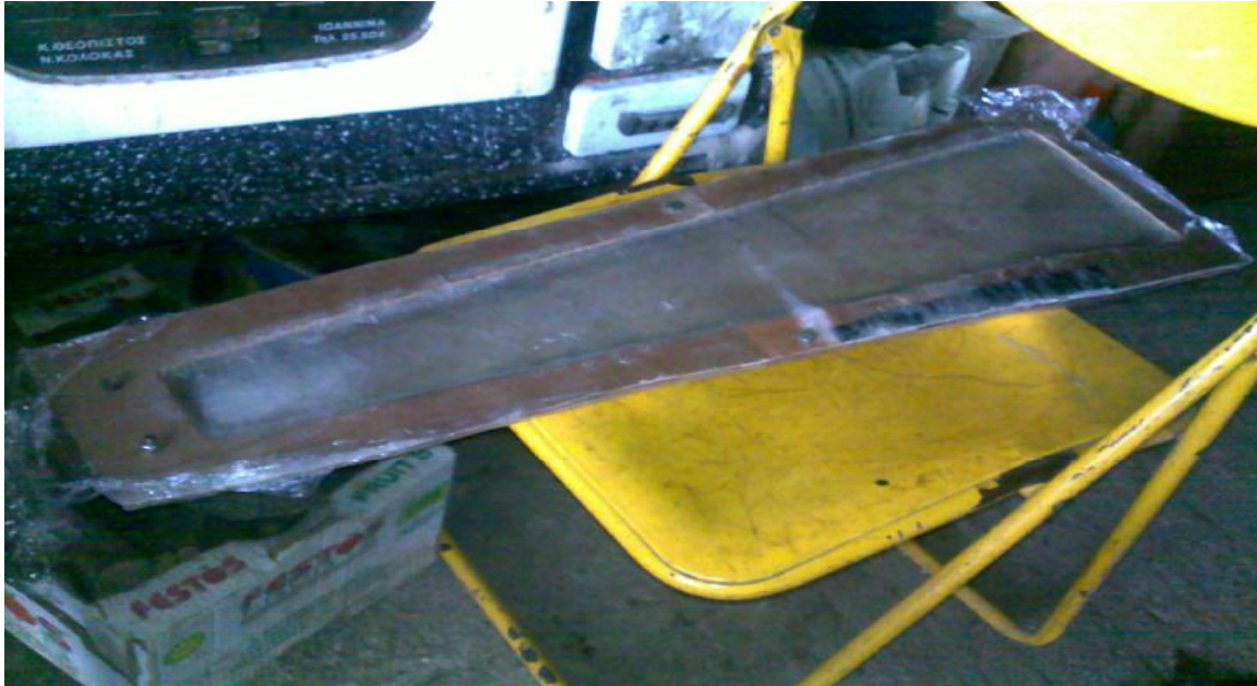
Εικόνα 11.5.5: Τα δύο μισά ενώθηκαν με κοχλίες και αφέθηκαν κοντά σε πηγή θερμότητας ώστε να στεγνώσει το πτερύγιο μέσα τους.
