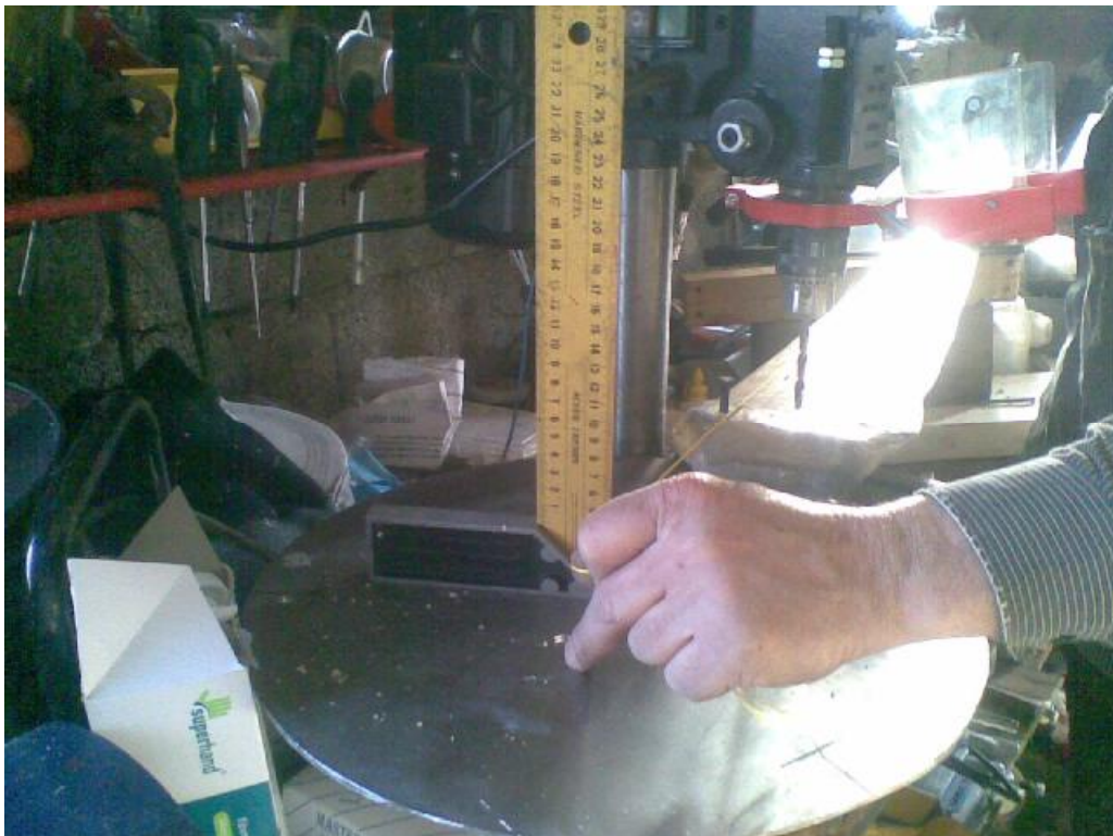
Εικόνα 11.8.4: Ευθυγράμμιση πτερυγίου με το κέντρο των δίσκων
