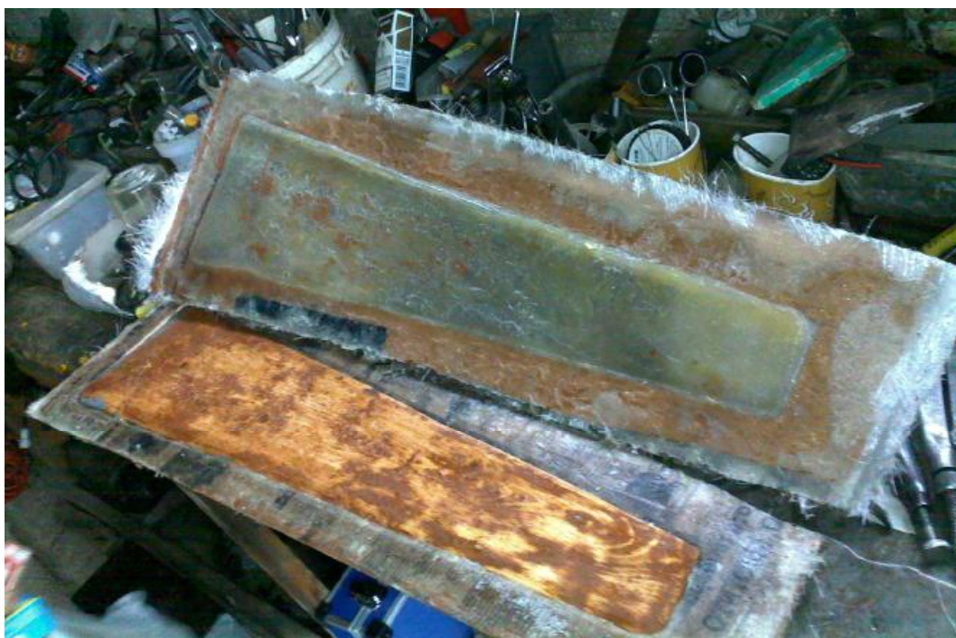
Εικόνα 11.4.2.8 Αποκόλληση του προτύπου πτερυγίου από το καλούπια.
