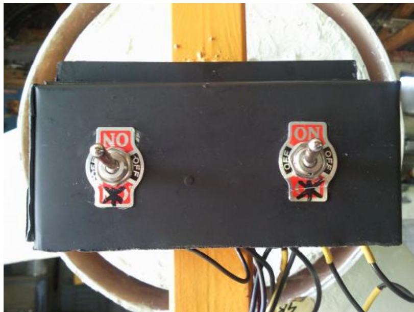
Εικόνα 13.5.3: Διακόπτες εναλλαγής μεταξύ των συνδεσμολογιών.
