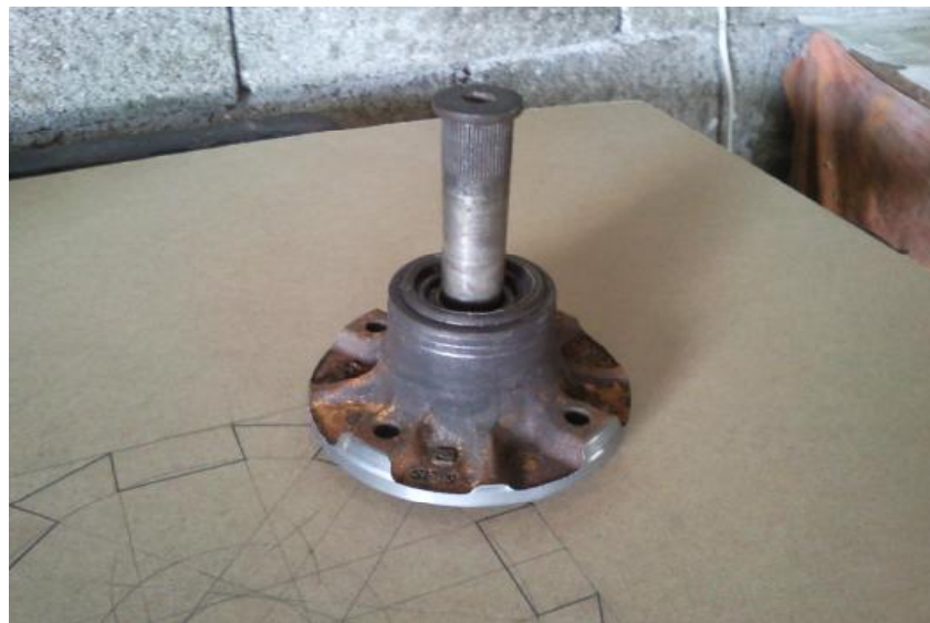
Εικόνα 12.2.2.2: Φαίνεται ο “σύνδεσμος” βάσει του οποίου θα ανοιχτούν οι οπές στο ξύλο
