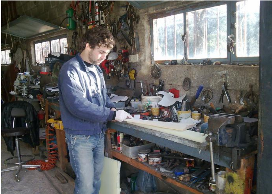
Εικόνα 11.3.18: Στάδιο φινιρίσματος με σμυριδόπανο.
