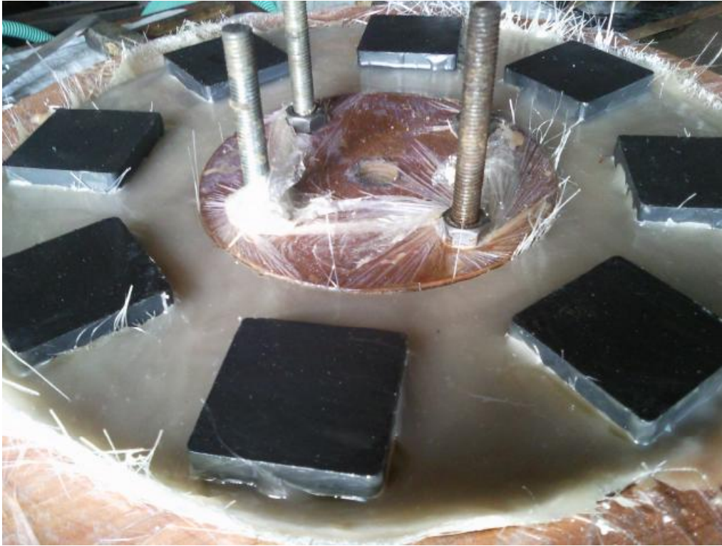
Εικόνα 12.2.10.6: Όψη δρομέα στο καλούπι.
