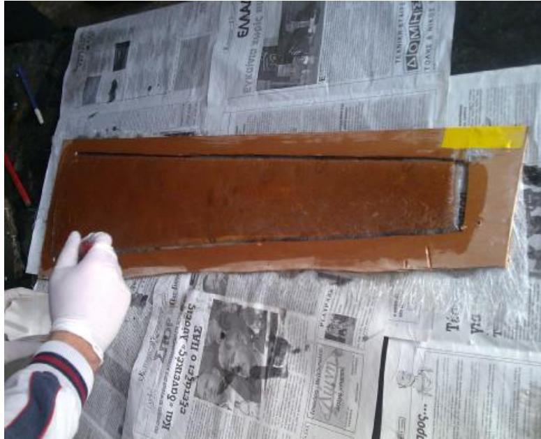
Εικόνα 11.4.2.1: Κατασκευή καλουπιού. Βάψιμο με πολυεστέρα.
