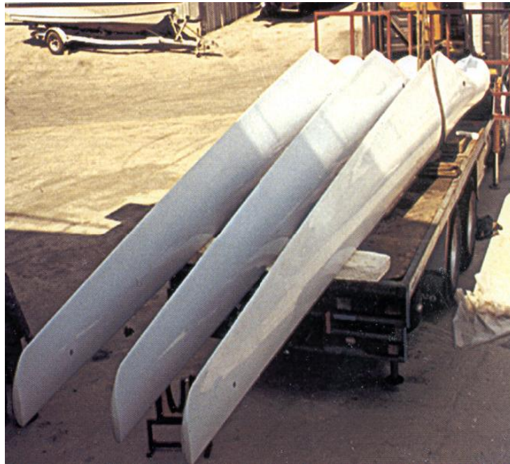
Σχήμα 6.4.9.2: Πτερύγια Α/Γ μήκους 24m από Fiberglass. Πηγή: Vestas
