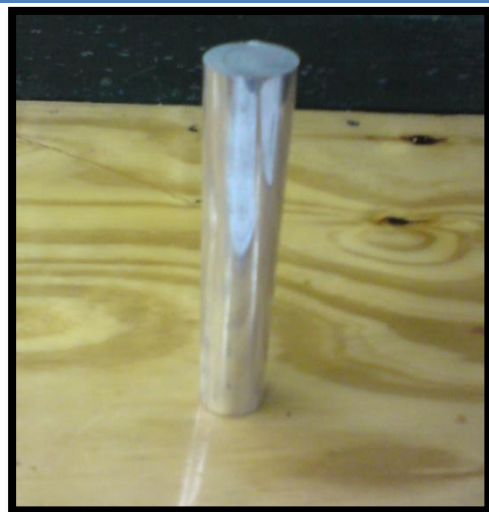
Εικόνα 3 : Μασίφ ράβδος αλουμινίου 28X200 mm
