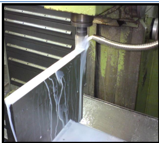
Εικόνα 10 : Γώνιασμα περιφερειακά της πλάκας
