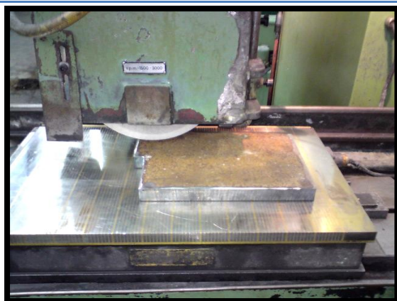
Εικόνα 8 : Πλάκα πριν την λείανση
