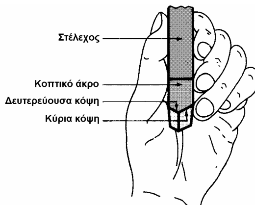
Σχήμα 1 Καθορισμός δεξιού ή αριστερού εργαλείου.
