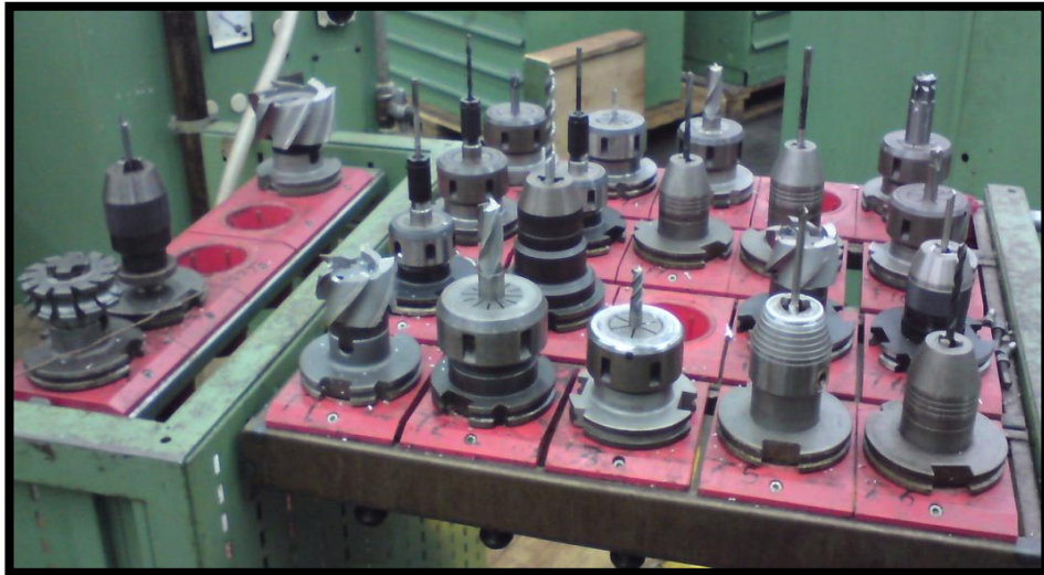
Εικόνα 8 : Κοπτικά εργαλεία διαφόρων μορφών φρέζας
