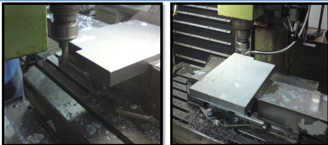
Εικόνα 7 : Αφαίρεση υλικού από την πλάκα
