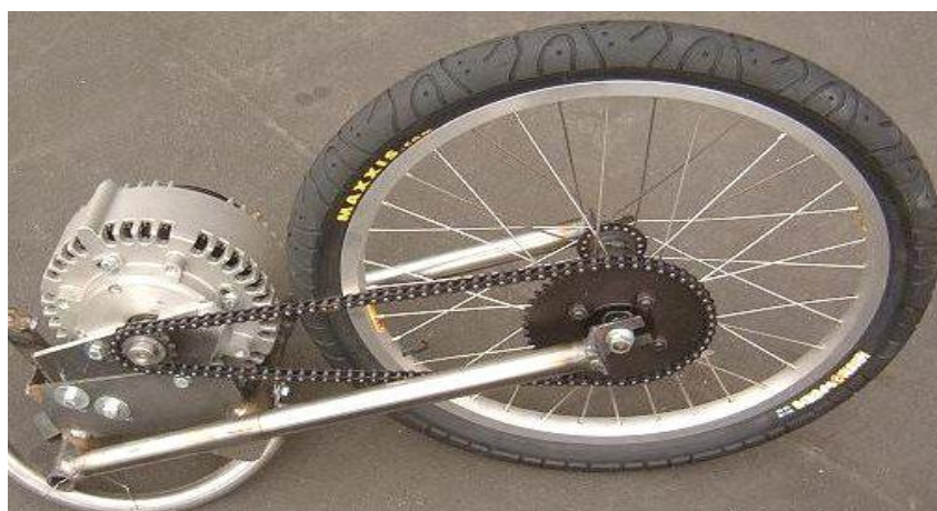
Σχήμα 4 : Κινητήρας που δίνει κίνηση στην ρόδα
