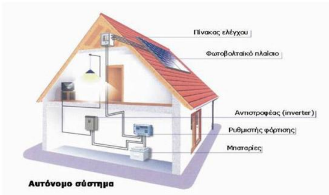
Σχήμα 11 : Βασικά μέρη ενός αυτόνομου συστήματος διασυνδεδεμένου συστήματος
