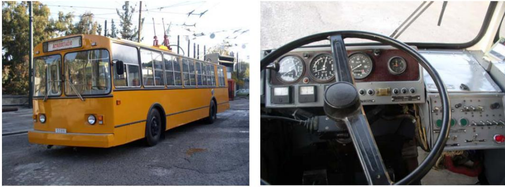
Εικόνα 1.5: Εξωτερική εμφάνιση και θέσης οδηγού τρόλλεϋ ρωσικού τύπου
