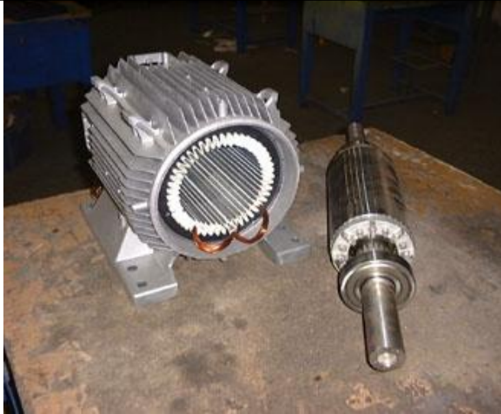
Εικόνα 5.1: Εσωτερικό ασύγχρονου κινητήρα στην οποία διακρίνονται όλα τα δομικά του στοιχεία
