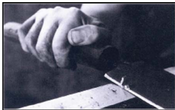
Εικόνα 3.17: Πλάνισμα της λεπίδας με το “Sen”
