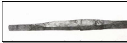
Εικόνα 3.15: Αρχική σφυρηλάτηση της λεπίδας “katana”
