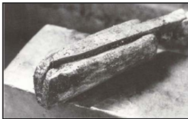
Εικόνα 3.12: Τελική μορφή χάλυβα με τη μέθοδο “ kobuse-gitae ”
