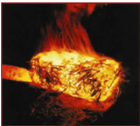
Εικόνα 3.9: Αναθέρμανση του μπλοκ
