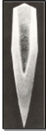
Εικόνα 3.13: Διατομή της λεπίδας “katana” με τη μέθοδο “kobuse-gitae”
