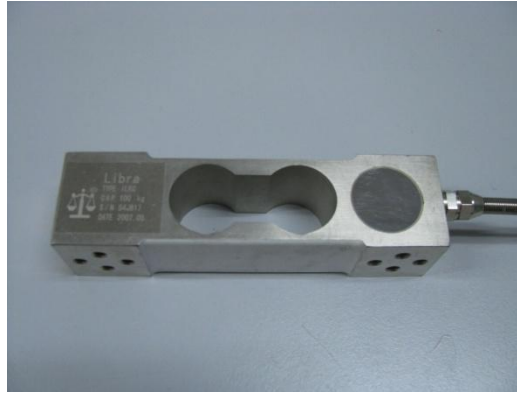
Εικόνα 3.6: Τύπου πλατφόρμας (καταπονείται σε κάμψη)
