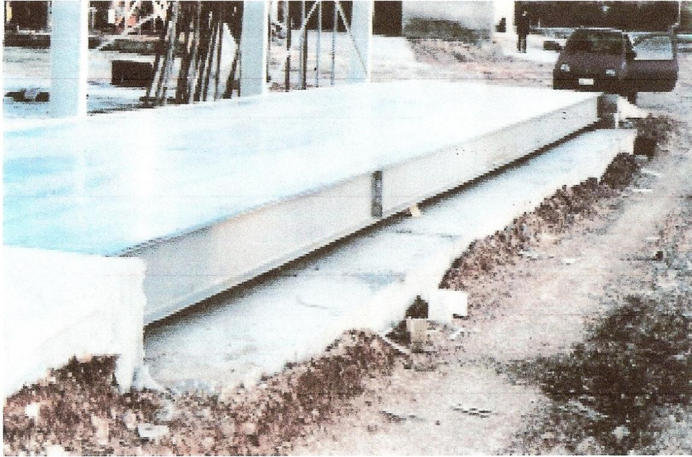
Εικόνα 2.3: Ηλεκτρονική γεφυροπλάστιγγα μεταλλικής κατασκευής επιφανειακής τοποθέτησης
