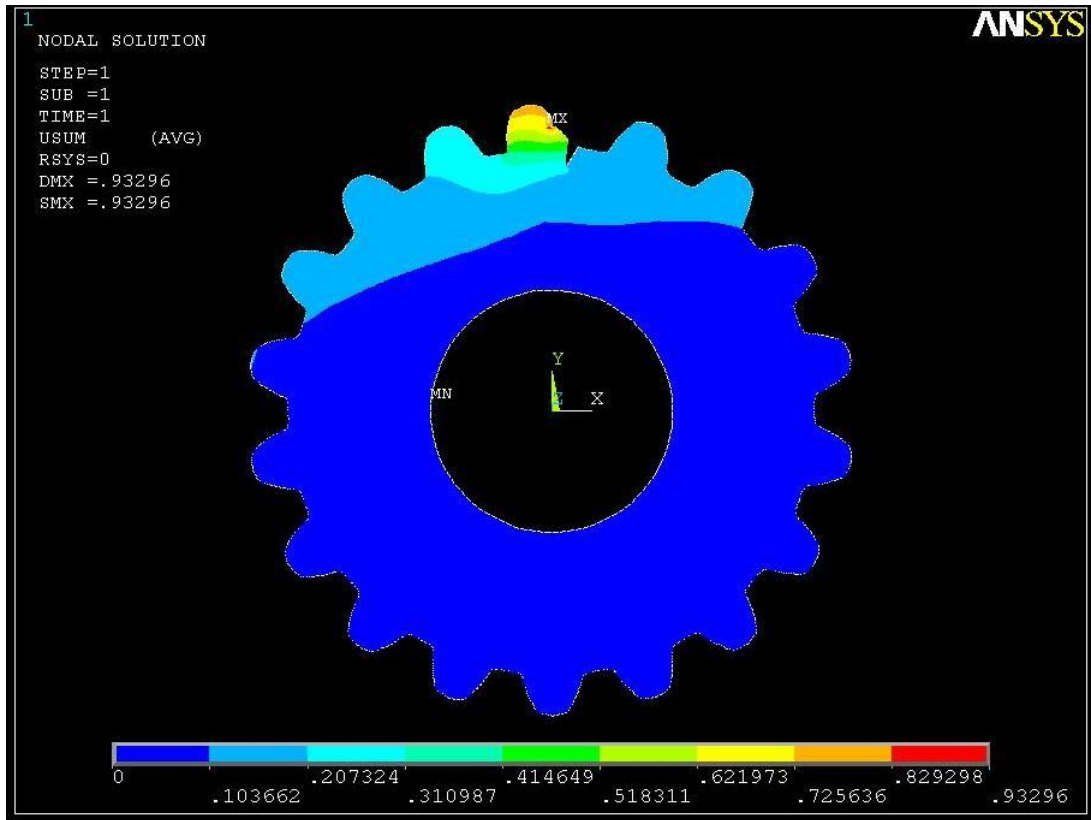
Σχήμα 3.18: Κατανομή μετατοπίσεων ρηγματωμένου γραναζιού.
