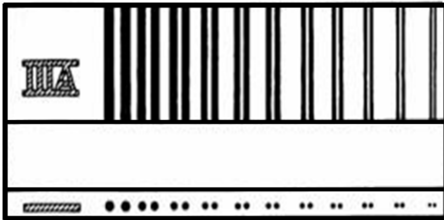
Εικόνα 1.13 : Δείκτες μέτρησης της ευαισθησίας των Ραδιογραφικών μεθόδων.
