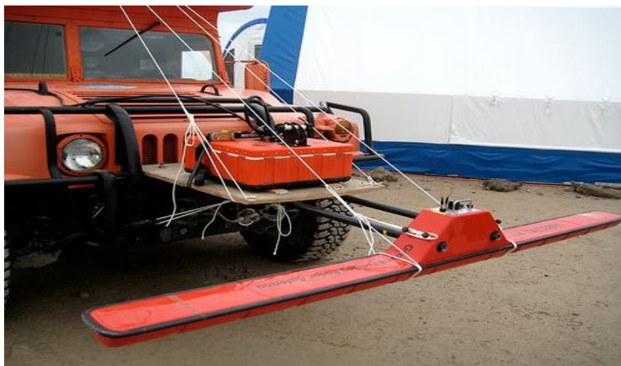
Εικόνα 5.2: Μπροστινή όψη οχήματος με κεραίες ψηφιακού σήματος
