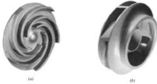
Σχήμα 2. 2 Αντλία ανοικτού τύπου (α) και κλειστού τύπου (β)
