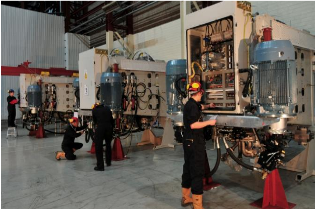
Πάνω: Η κατασκευή τών υποσυστημάτων ενέργειας του Pelamis .
