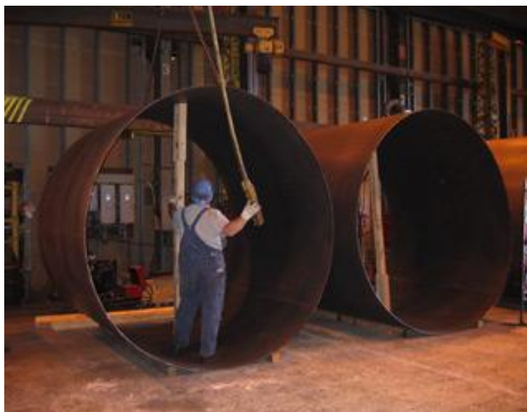
Πάνω: Στάδιο κατασκευής του άξονος του Aquabuoys.
