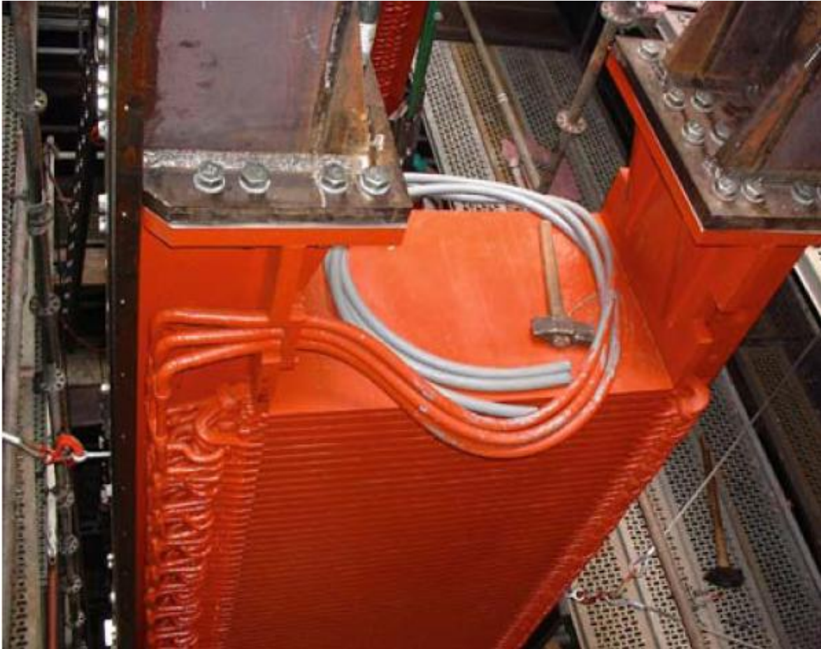
Πάνω: Ό στάτωρ της γεννήτριας του Archimedes Wave Swing
