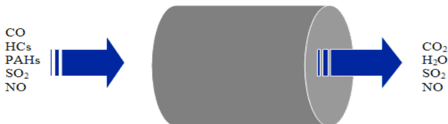
Εικόνα 6.10: Η λειτουργία του οξειδωτικού καταλύτη.
