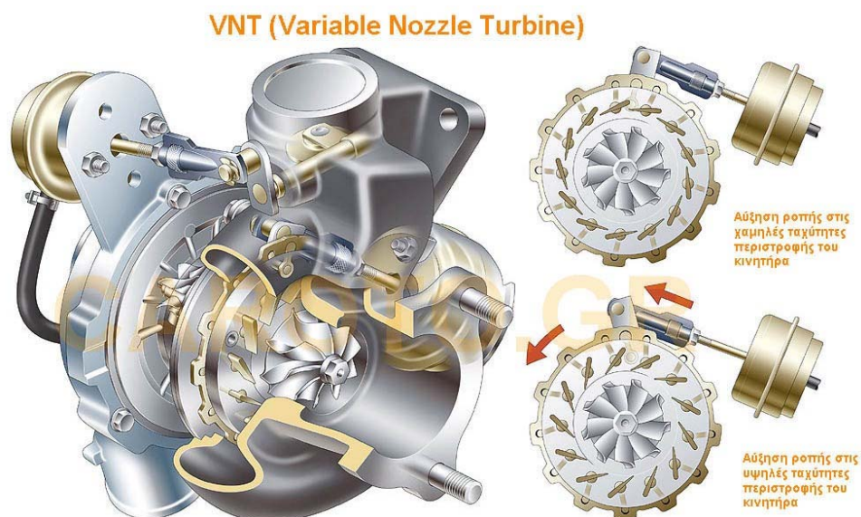
Εικόνα 5.9: Σύστημα υπερτροφοδότησης μεταβαλλόμενης γεωμετρίας από πετρελαιοκινητήρα της Volvo.
