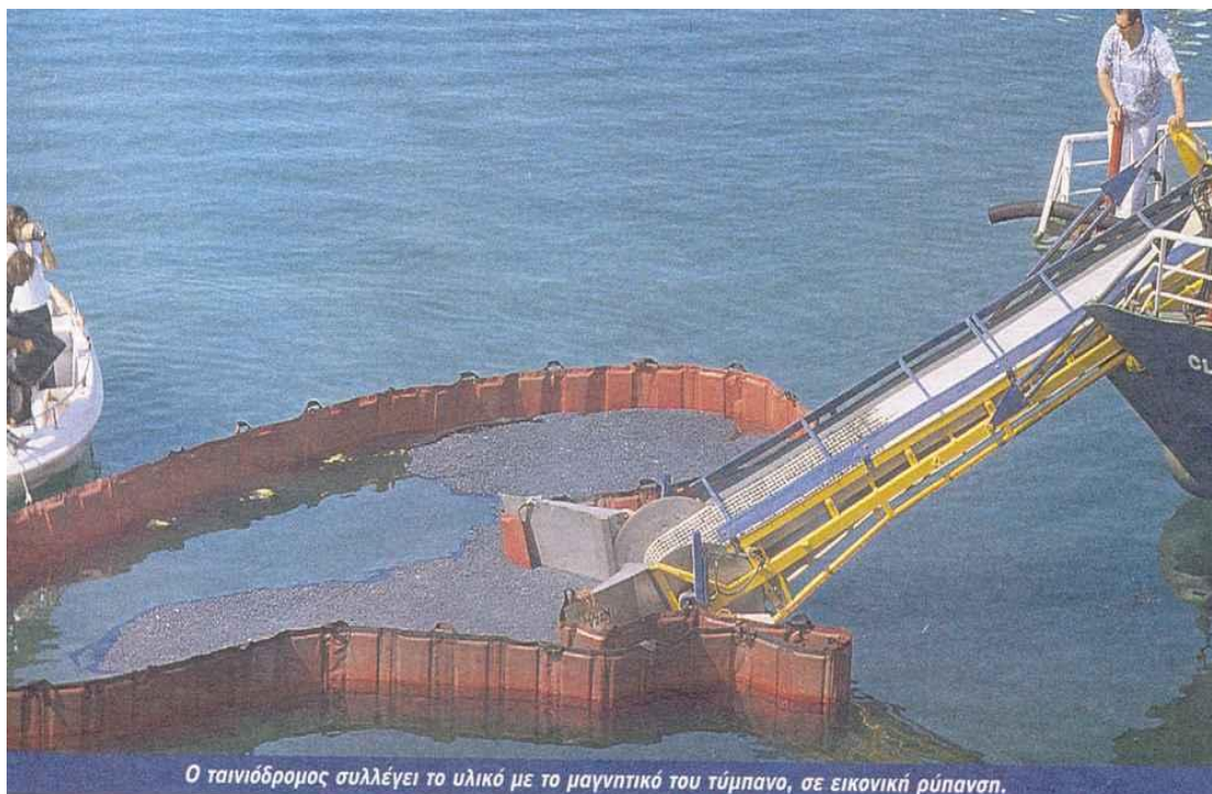
Εικόνα 4.3 Ταινιόδρομος συλλέγει το υλικό με μαγνητικό τύμπανο.
