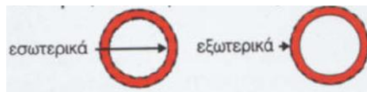
Εικόνα 17: Θέσεις καθαρισμού σωλήνα
