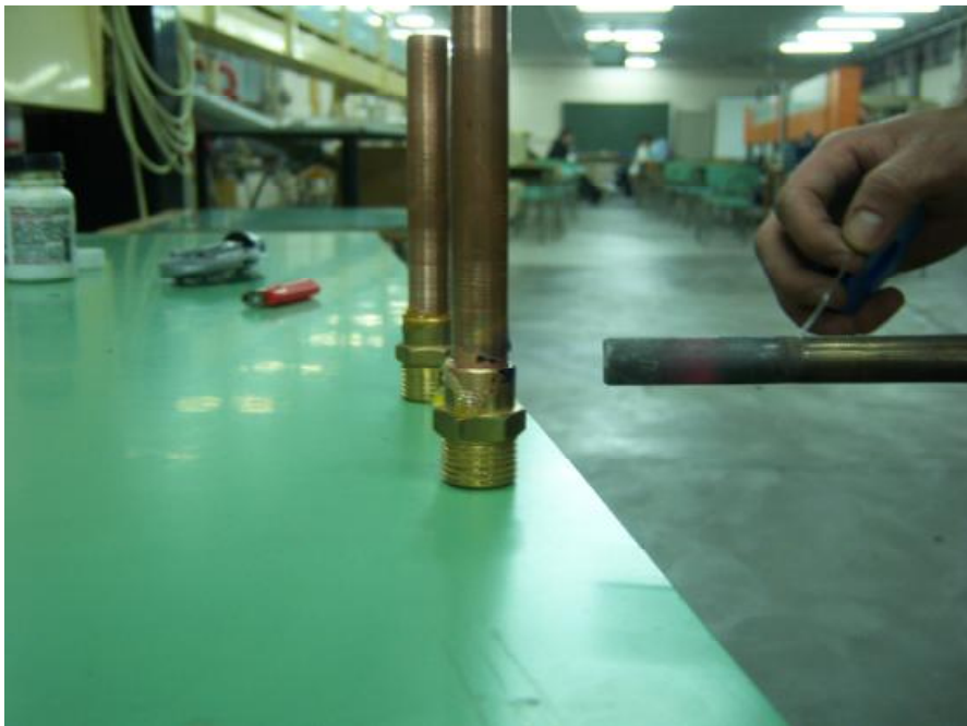
Εικόνα 37:Κόλληση χαλκοσωλήνα με ρακόρ του ογκομετρικού ρολογιού
