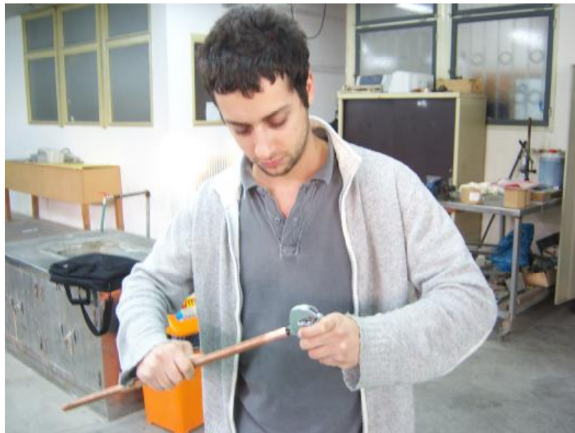
Εικόνα 33: Καθαρισμός της περιοχής κόλλησης των χαλκοσωλήνων, εσωτερικά με χρήση του σωληνοκόφτη
