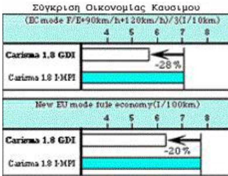
Σχήμα 2.13.3 : Σύγκριση κινητήρα GDI με συμβατικό MPI στην οικονομία καυσίμου.
