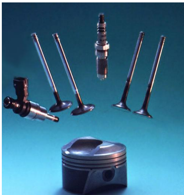
Εικόνα 6.2.2 : Διάταξη θαλάμου καύσης άμεσου ψεκασμού.
