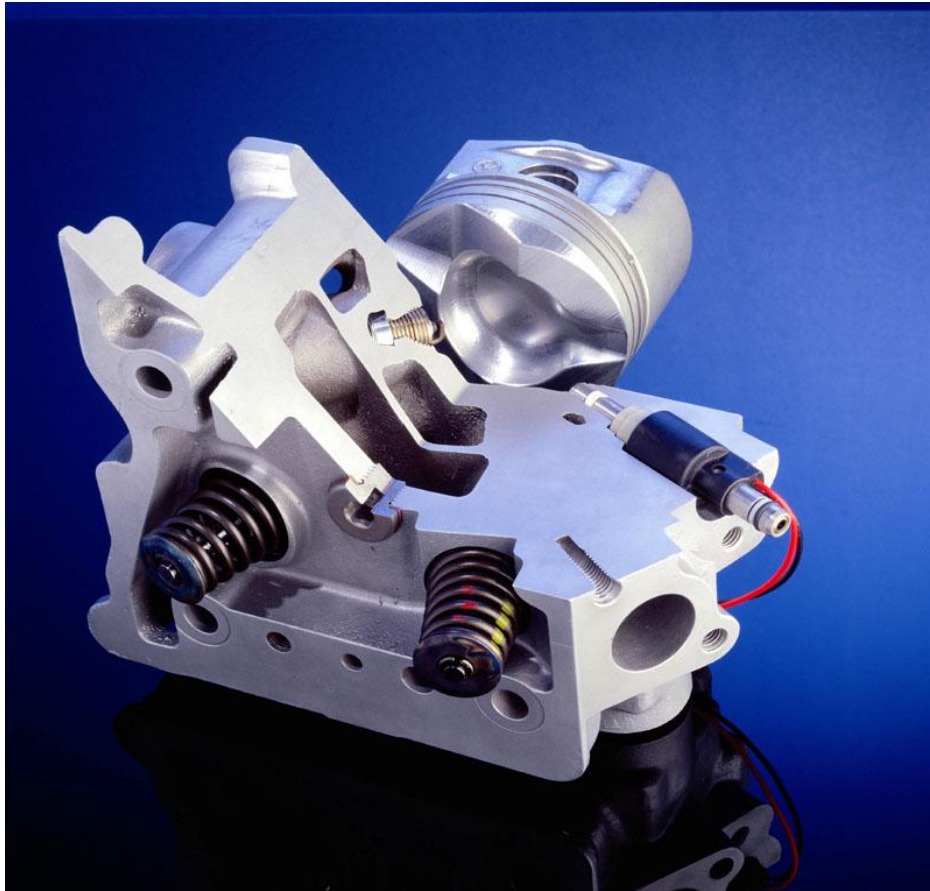
Εικόνα 2.9.5 : Κυλινδροκεφαλή άμεσου ψεκασμού σε τομή.
