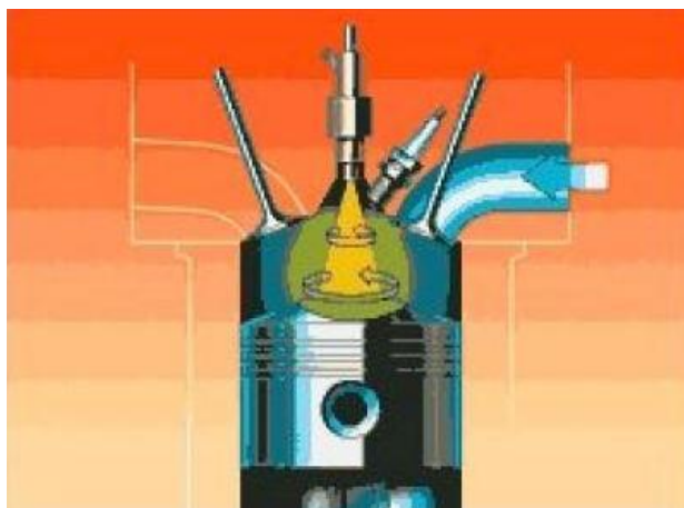
Σχήμα 2.16.3 : Στροβιλισμός και ανάμειξη του μίγματος.
