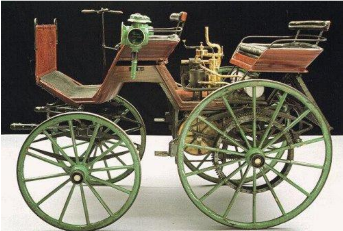
Εικόνα 1.1.4 : Τροποποιημένη αλογοάμαξα με τετράχρονο βενζινοκινητήρα.
