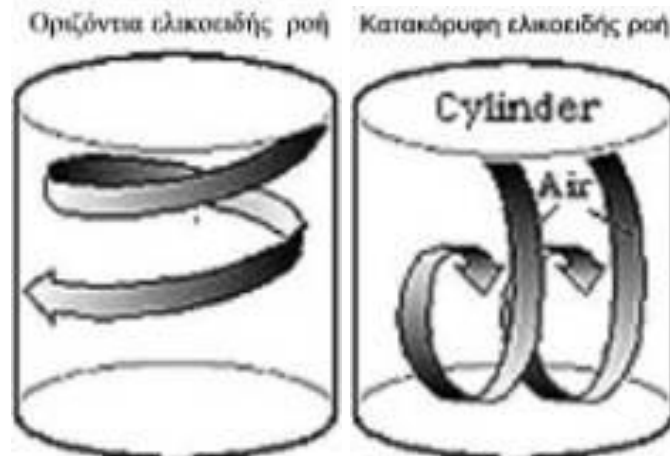
Σχήμα 2.9.4 : Ροή μίγματος - Ροή εισερχόμενου αέρα.
