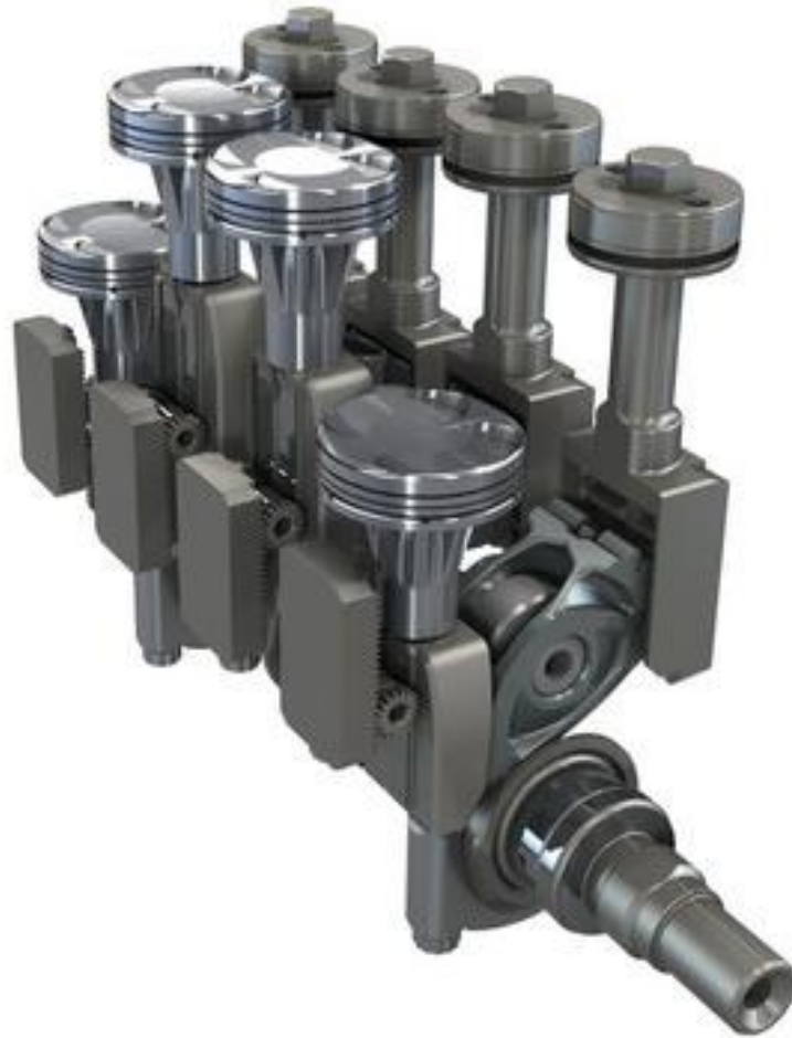
Εικόνα 5.4.1 : Θέσεις ρυθμιστικών και καθοδηγούμενων εμβόλων.
