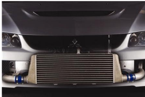
Εικόνα 4.6.3 : Front mounted εναλλάκτης θερμότητας.
