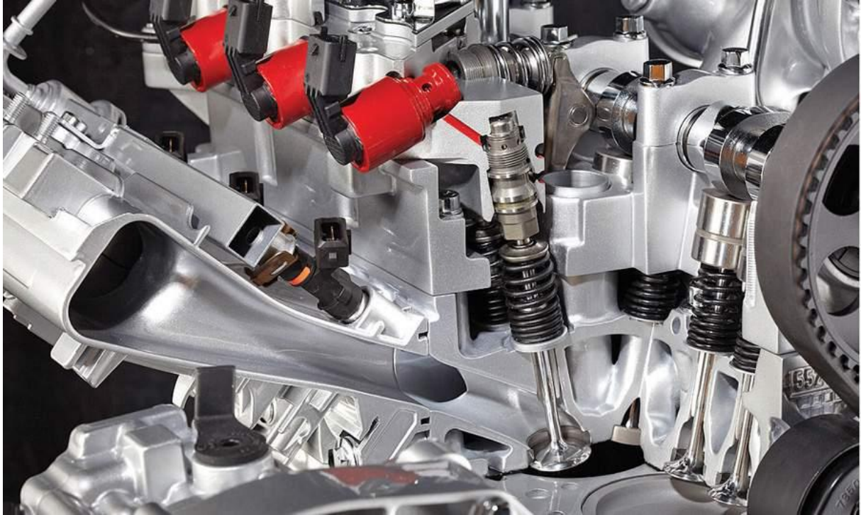
Εικόνα 3.5.6 : Κινητήρας Multiair σε τομή.
