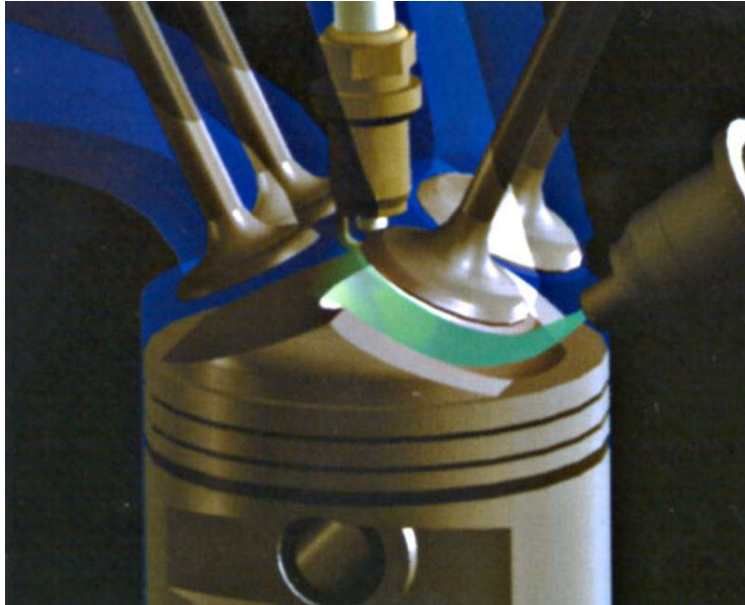
Σχήμα 2.13.2 : Ψεκασμός καυσίμου λίγο πριν το ΑΝΣ.
