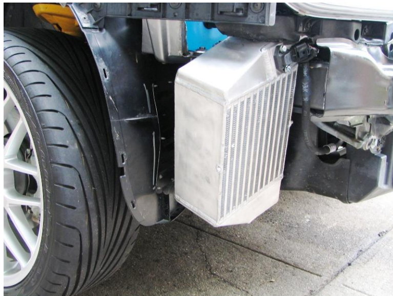
Εικόνα 4.6.4 : Side mounted εναλλάκτης θερμότητας.
