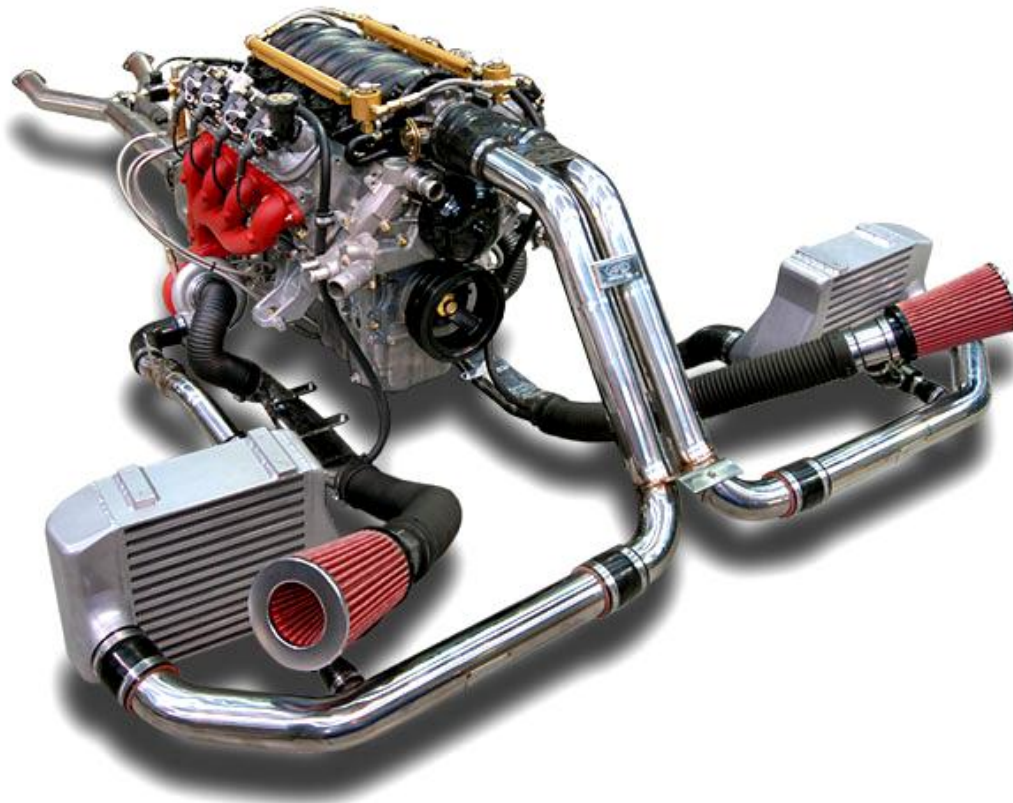
Εικόνα 4.11.2 : Κινητήρας με παράλληλο biturbo.
