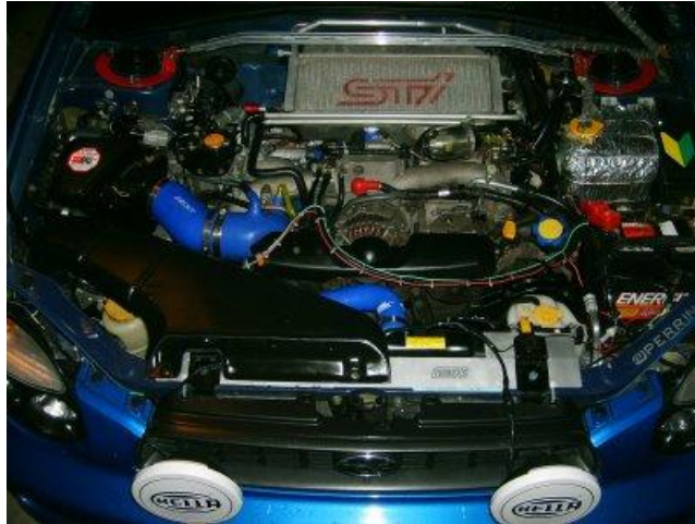
Εικόνα 4.6.5 : Top mounted εναλλάκτης θερμότητας.
