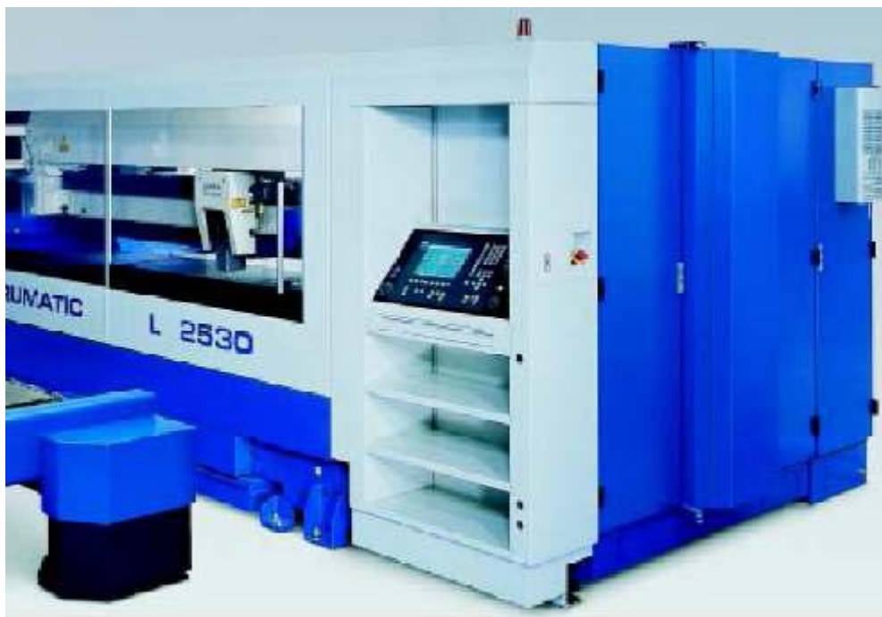
Σχήμα 4-1: Μηχανή κατεργασίας με δέσμη Laser TRUMPF TRUMATIC TLF 2530.
