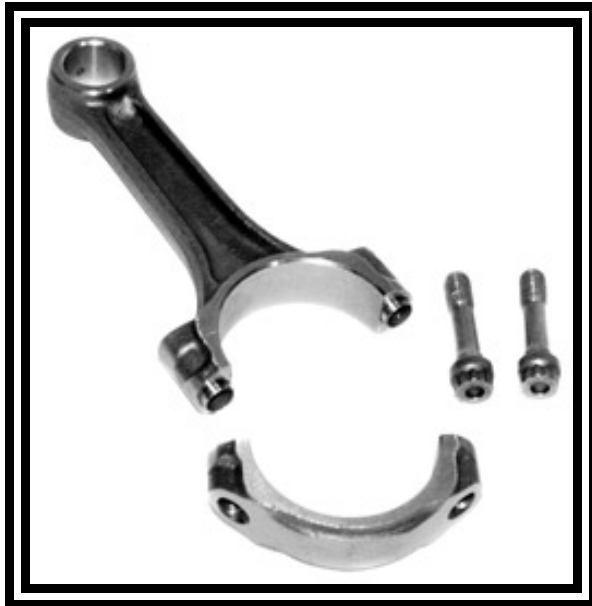
Εικόνα 3.25: Μπιέλα με αφαιρούμενο καβαλέτο
