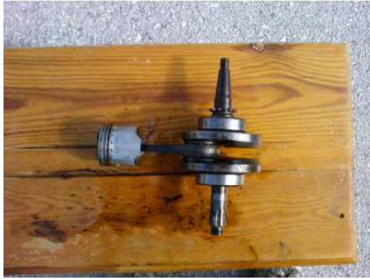
Εικόνα 4.23: στροφαλοφόρος άξονας κιν. μαζί με διωστήρα και πιστόνι
