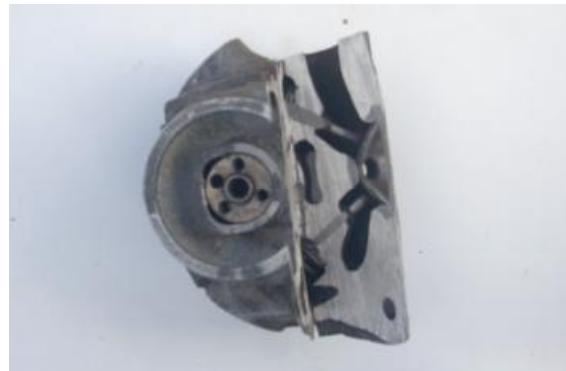
Εικόνα 4.20: κεφαλή κινητήρα μετά την τομή
