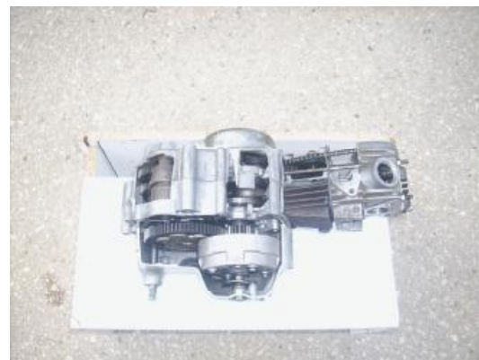
Εικόνα 4.27: κάτω όψη κινητήρα σε τομή
