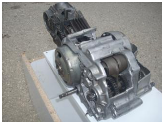
Εικόνα 4.26: πίσω όψη κινητήρα σε τομή
