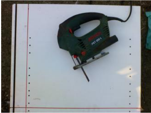
Εικόνα 4.28: κατασκευή βάσης κινητήρα
