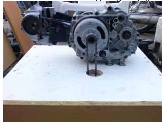
Εικόνα 4.31: κινητήρας σε τομή τοποθετημένος πάνω στη βάση
