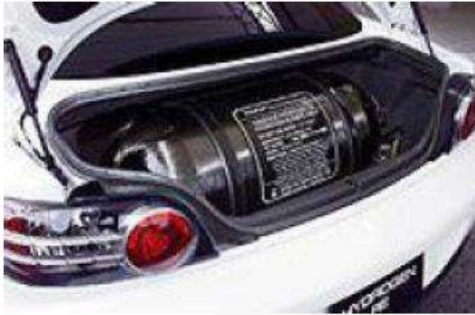
Εικόνα 9.5: Η δεξαμενή υδρογόνου στον χώρο αποσκευών του οχήματος
