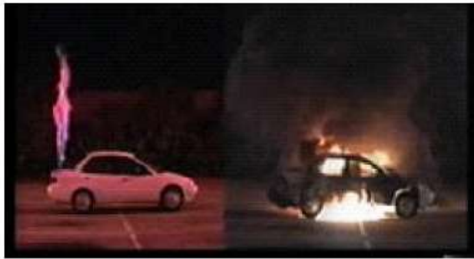
Εικόνα 4.4: Αριστερά, διακρίνεται η διάχυση του υδρογόνου ύστερα από εκούσια ανάφλεξη του ρεζερβουάρ υδρογόνου. Στα δεξιά παρατηρούμε την ολοσχερή καταστροφή άλλου αυτοκινήτου με ρεζερβουάρ βενζίνης, ύστερα από παρόμοια ανάφλεξη
