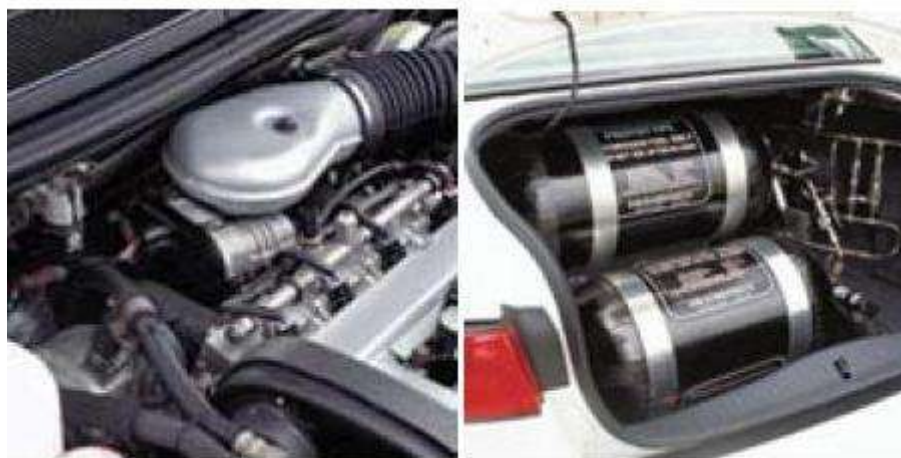
Εικόνα: 9.14: Κινητήρας καύσης υδρογόνου και δεξαμενές καυσίμου στο χώρο αποσκευών του Ford P2000
