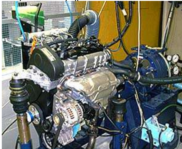
Εικόνα 9.7: Η ισπανική μηχανή υδρογόνου, είναι σε ονομαστική ταχύτητα της τάξης των 84 μίλια/ώρα και φτάνει σε RPM τις 5000 στροφές.
