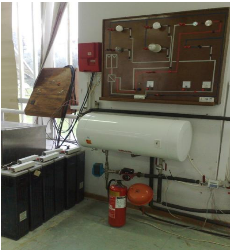
Σχήμα 3.3: Συσσωρευτές που τροφοδοτούνται από τρία PV SM55 χρησιμοποιώντας μετατροπέα δίνοντας ρεύμα στο παραπάνω πίνακα ελέγχου.
