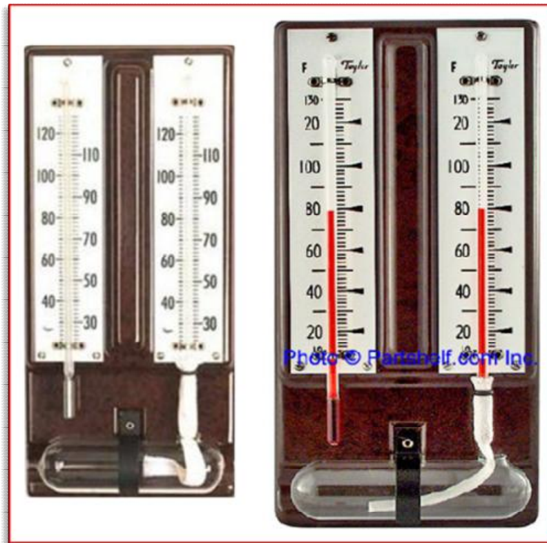
Εικ. 12.1: Διπλά Θερμόμετρα τα οποία είναι ικανά να μετρήσουν θερμοκρασία ξηρού βολβού και θερμοκρασία υγρού βολβού. (στην δεξιά πλευρά μετράται η Θ.Υ.Β και στην αριστερή η Θ.Ξ.Β )
