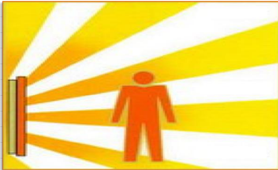
Εικ. Β.3: Παράδειγμα μετάδοσης θερμότητας με ακτινοβολία από καλοριφέρ.
