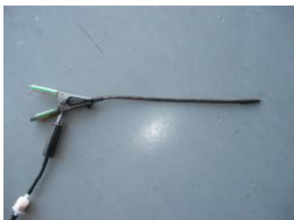
Εικόνα 7: Εύκαμπτος σωλήνας αναρρόφησης καυσαερίων
