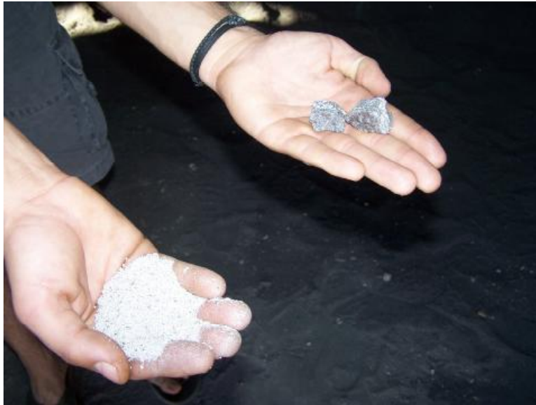
Εικ. 20 Αριστερά διακρίνουμε διάφορα αντισκωριακά υλικά και δεξιά τον φώσφορο
