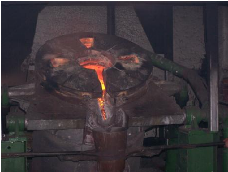
Εικ. 17 Μετάγγιση χυτού σε μικρότερα χωνιά
