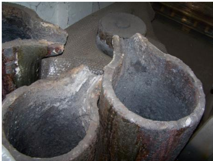
Εικ. 14 Μεταφορείς: είναι τα μικρότερα χωνιά στα οποία μεταγγίζεται το χυτό για την τελική χύτευση
