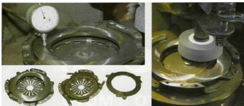
Εικόνα 1.16 : Διαδικασία ρεκτιφιαρίσματος του πλατό
