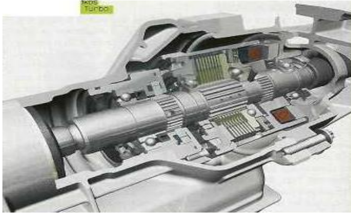
Εικόνα 3.11 : Ηλεκτρομαγνητικά ελεγχόμενος πολυδίσκος συμπλέκτης
