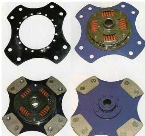
Εικόνα 1.14 : Φάσεις μετατροπής ενός δίσκου
