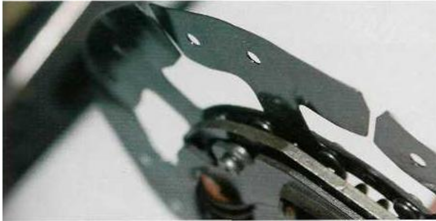
Εικόνα 1.13 : Τα πτερύγια του δίσκου
