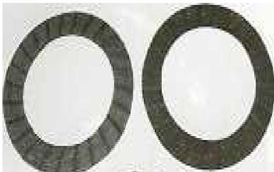
Εικόνα 1.10 : Φερμουίτ από αμιαντούχο υλικό (αριστερά) και χωρίς αμιάντο
