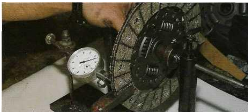
Εικόνα 1.15 : Ειδική βάση για τον έλεγχο του δίσκου
