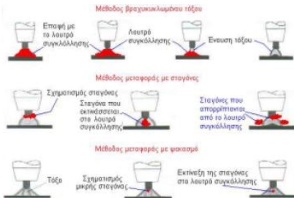
Σχήμα 21. Η μεταφορά βραχυκυκλωμένου τόξου, με σταγόνες και με ψεκασμό
