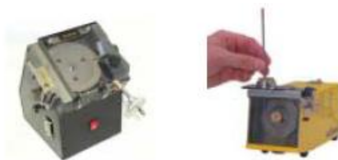
Σχήμα 33: Ειδικά τροχιστικά μηχανήματα, για το τρόχισμα των μη αναλώσιμων ηλεκτροδίων
