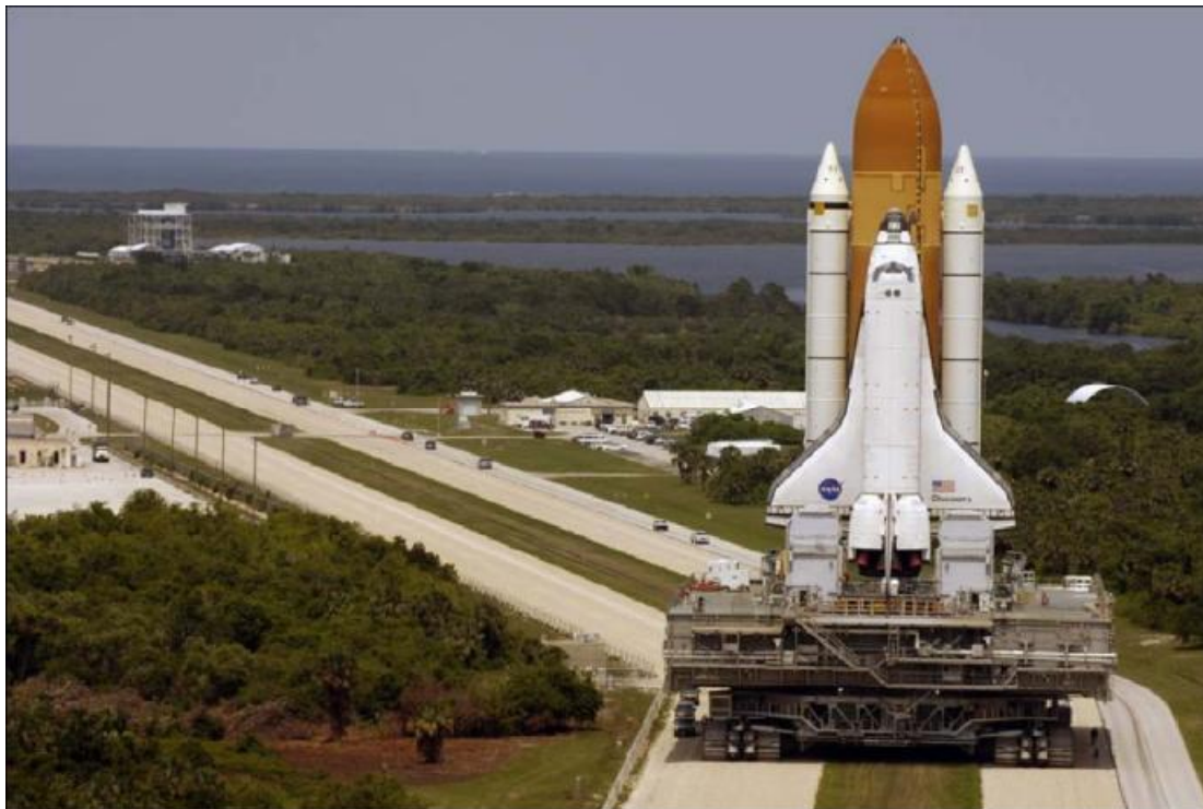
Σχήμα 3.15 Το Διαστημικό Λεωφορείο Discovery τοποθετημένο πάνω στην Κινητή Πλατφόρμα Εκτόξευσης στρίβει με το Όχημα μεταφοράς (Crawler Transporter) στον δρόμο μετάβασης (Crawlerway) κατευθυνόμενο στο Συγκρότημα Εκτόξευσης 39-B .
