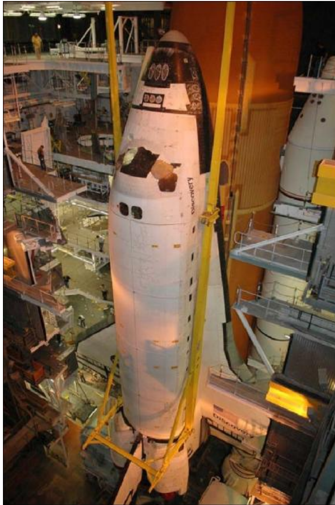
Σχήμα 3.10 Μέσα στο Υπόστεγο 3 (High Bay 3) πραγματοποιούνται οι τελευταίες διαδικασίες σύνδεσης του Τροχιακού Οχήματος Discovery με την Εξωτερική Δεξαμενή ET-121 και τους Πυραύλους Στερεών Καυσίμων SRB .
