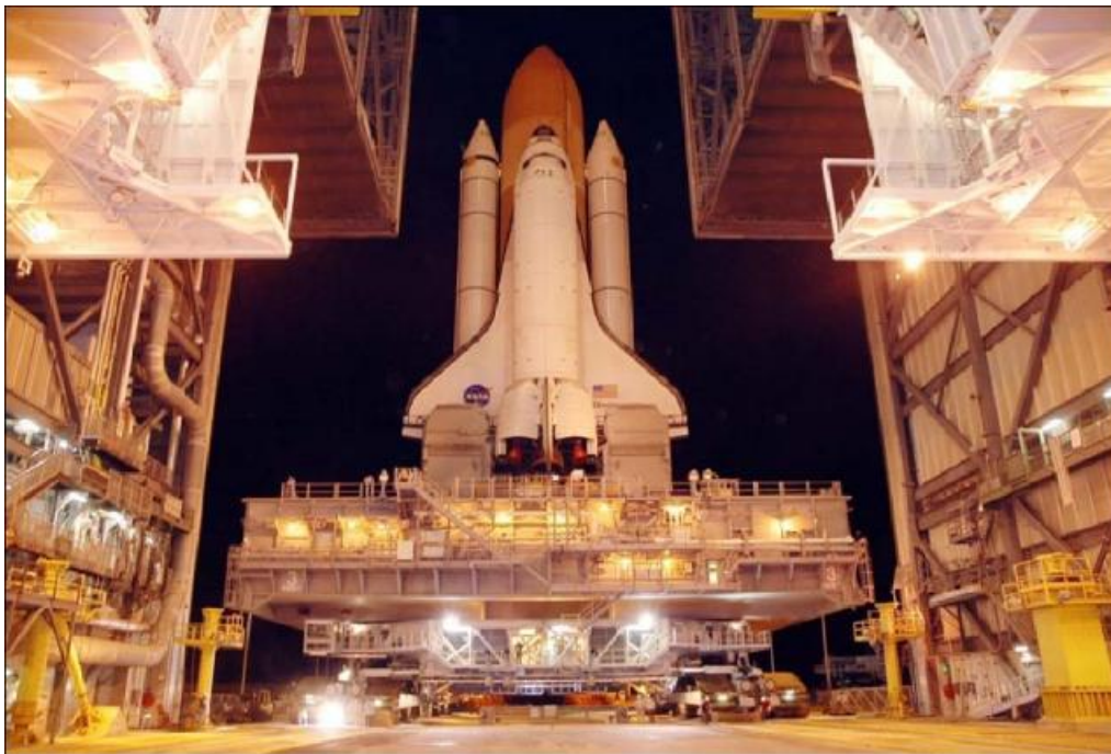
Σχήμα 3.11 Το Τροχιακό Όχημα Discovery βγαίνει από το Υπόστεγο 3 (High Bay 3) με τη βοήθεια του Οχήματος Μεταφοράς (Crawler Transporter) πάνω στην Κινητή Πλατφόρμα Εκτόξευσης καθώς ξεκινάει το «ταξίδι» του μέχρι το Συγκρότημα Εκτόξευσης 39-B .
