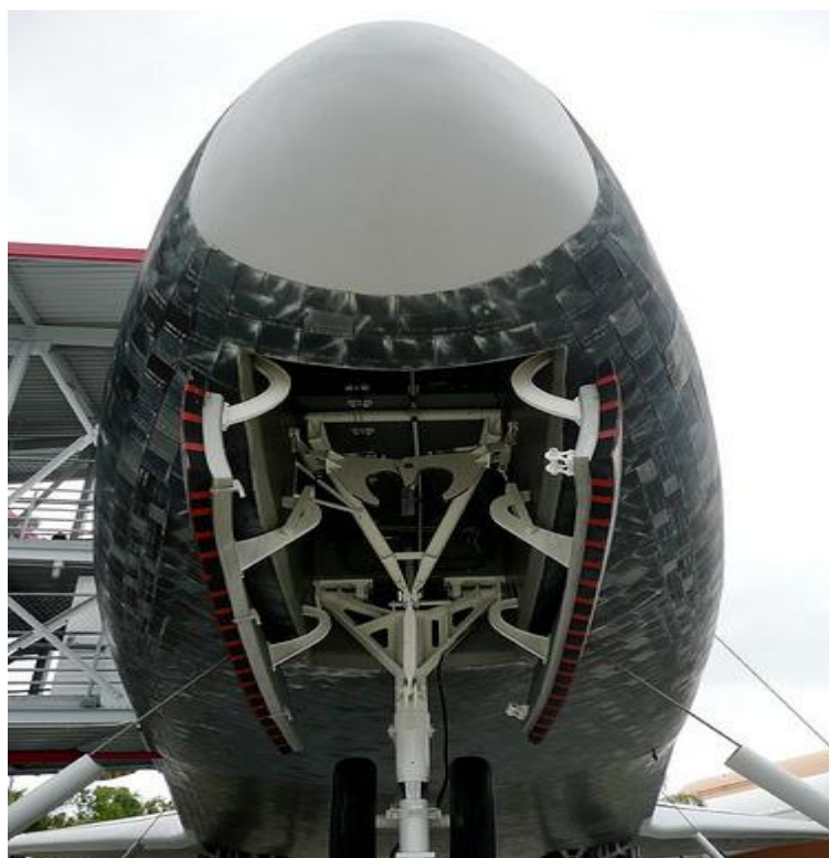
Σχήμα 5.1 Μονωτικά πλακίδια στην άτρακτο του διαστημικού οχήματος
