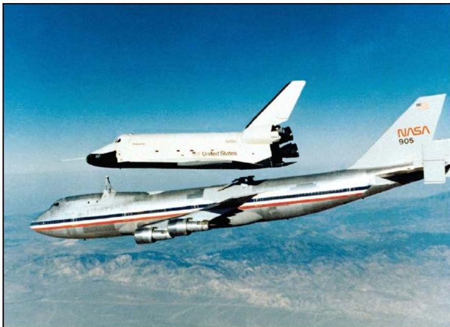
Σχήμα 1.2 Το πρώτο Τροχιακό Όχημα ήταν το Enterprise, εδώ εμφανίζεται να αφήνεται από το Boeing 747 Shuttle Aircraft κατά τη διάρκεια των Δοκιμών Προσέγγισης και Προσγείωσης στην Αεροπορική Βάση Edwards
