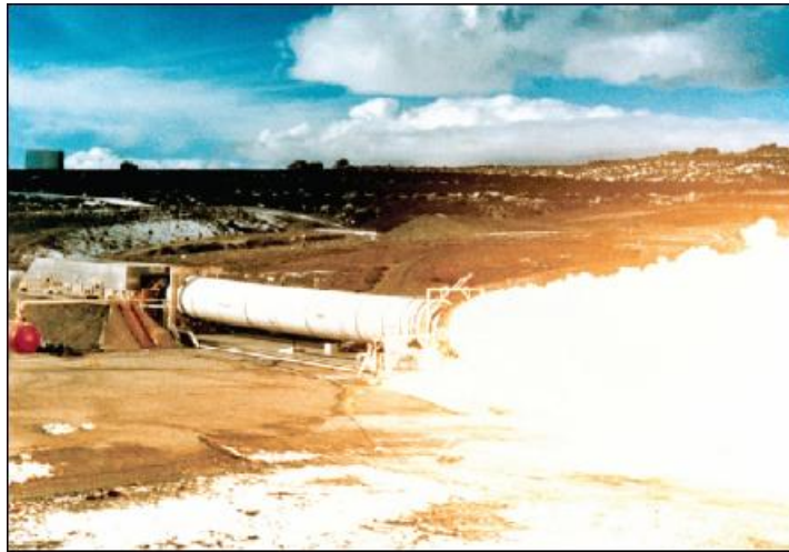
Σχήμα 2.21 Ένας δοκιμαστικός πυραυλοκινητήρας του Πυραύλου Στερεών Καυσίμων SRB δοκιμάζεται κοντά στην πόλη Brigham της Γιούτα.
