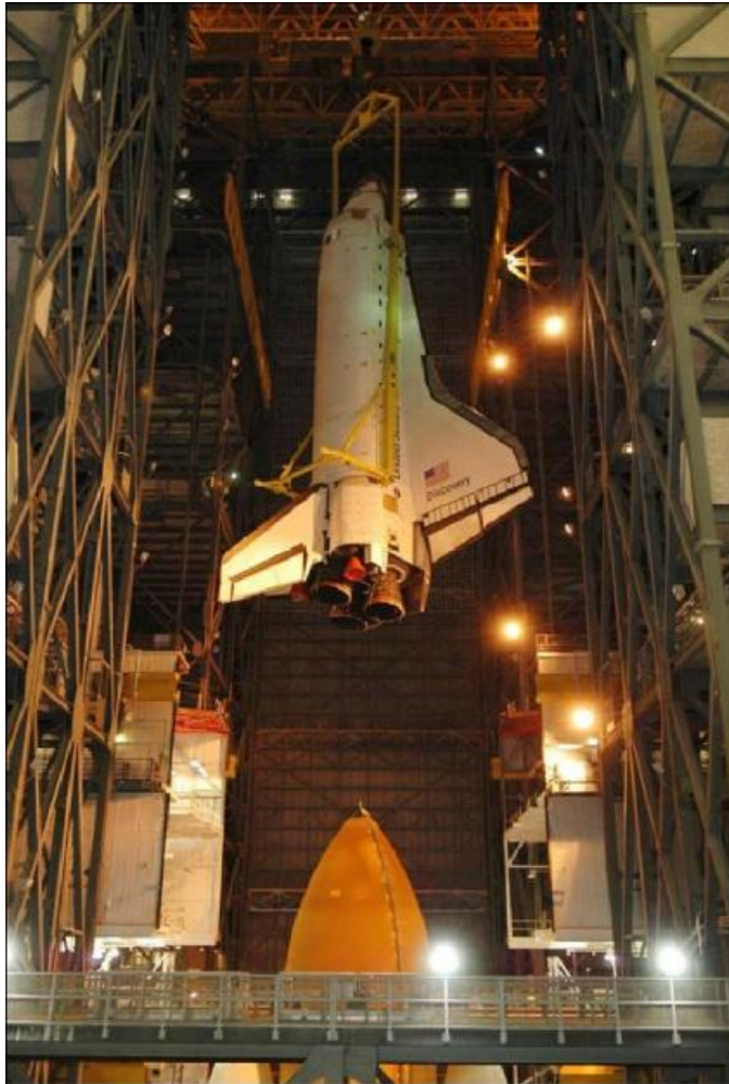
Σχήμα 3.9 Το Τροχιακό Όχημα Discovery, μήκους 37 m κρέμεται αναρτημένο έτοιμο να προσδεθεί στην Εξωτερική Δεξαμενή ET-121 και τους Πυραύλους Στερεών Καυσίμων SRB .
