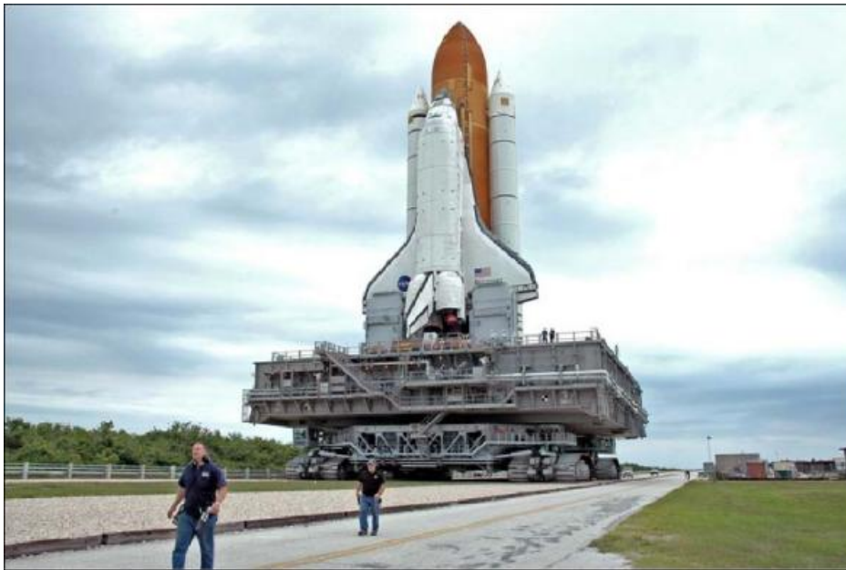
Σχήμα 3.12 Το Τροχιακό Όχημα Discovery πάνω στο Όχημα Μεταφοράς (Crawler Transporter) στη διάρκεια του «ταξιδιού» του από το Κτίριο Συναρμολόγησης του Οχήματος VAB στο σημείο της εκτόξευσης.
