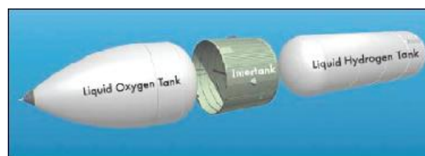
Σχήμα 2.18 Τα κύρια μέρη της Εξωτερικής Δεξαμενής ET
