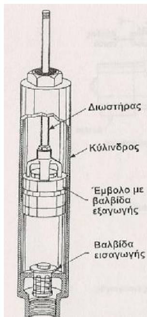
Σχήμα 7.23 Σχηματική απεικόνιση εμβολοφόρου αντλίας. (Γ.Α. Καλλέργης 1999)
