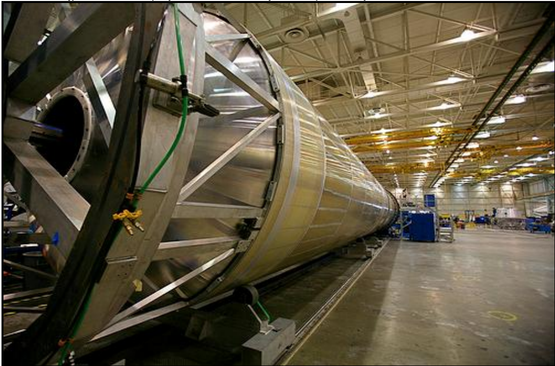
Το δοχείο καυσίμων πυραύλου Falcon 9. Διακρίνονται καθαρά οι ραφές της FSW [157]
