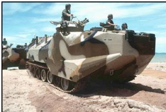
Άρμα μάχης AAVV του αμερικανικού στρατού. Η θωράκιση του έχει συγκολληθεί με την μέθοδο FSW[160]
