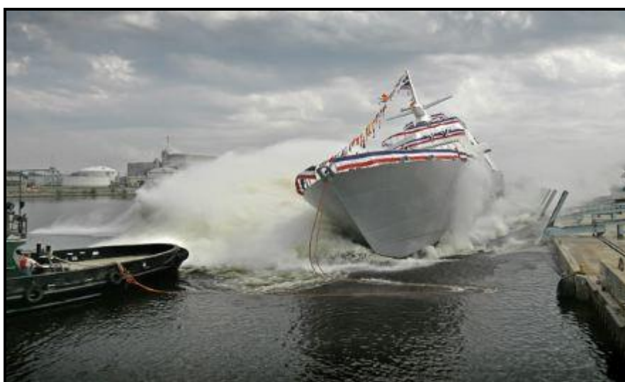
Η καθέλκυση του αμερικανικού πολεμικού πλοίου Littoral Σεπτέμβριος 2006. Το κήτος του σκάφους έχει συγκολληθεί με την μέθοδο FSW[161]
