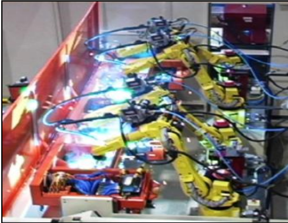
Εγκατάσταση συγκόλλησης Laser αυτοκινητοβιομηχανίας [54]
