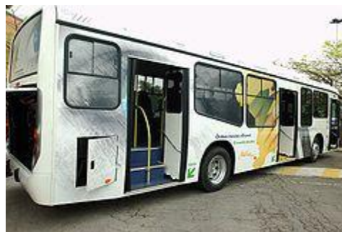
Εικόνα 7.2. Δοκιμαστικό λεωφορείο που λειτουργεί με E95 στο Sao Paolo της Βραζιλίας
