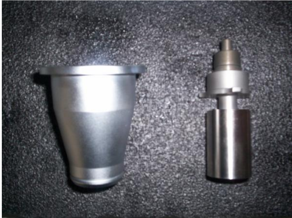
Εικόνα 3.1.1-2 Μέρη ρεομέτρου που χρησιμοποιούνται για μετρήσεις με τη μέθοδο Couette.
