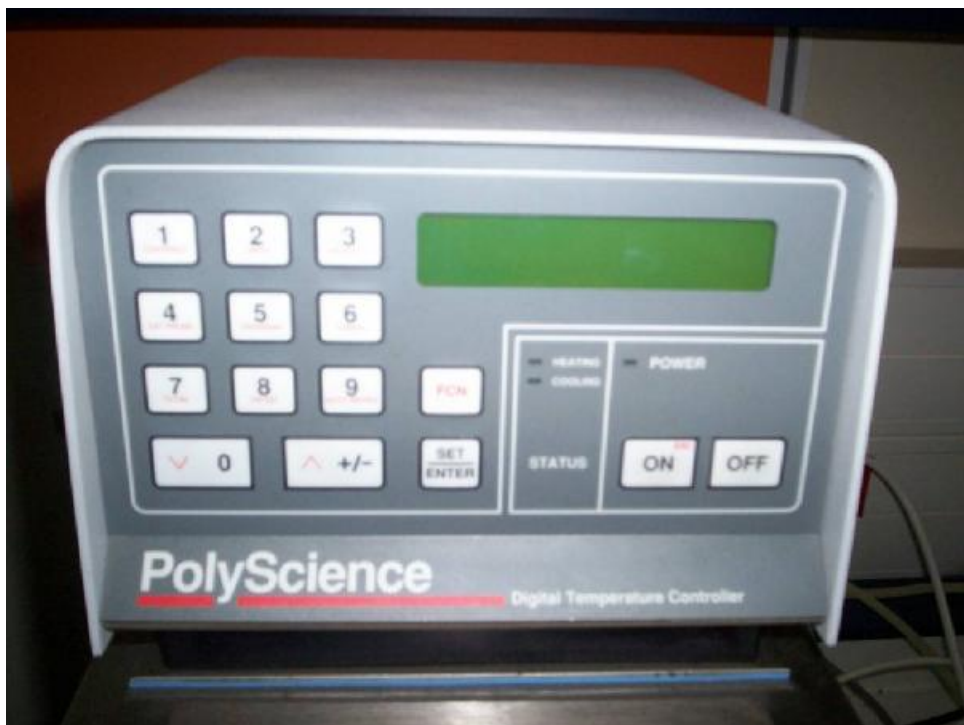
Εικόνα 3.1.1-3 Αναπόσπαστο κομμάτι της πειραματικής διάταξης του ρεομέτρου για τη ρύθμιση της θερμοκρασίας .
