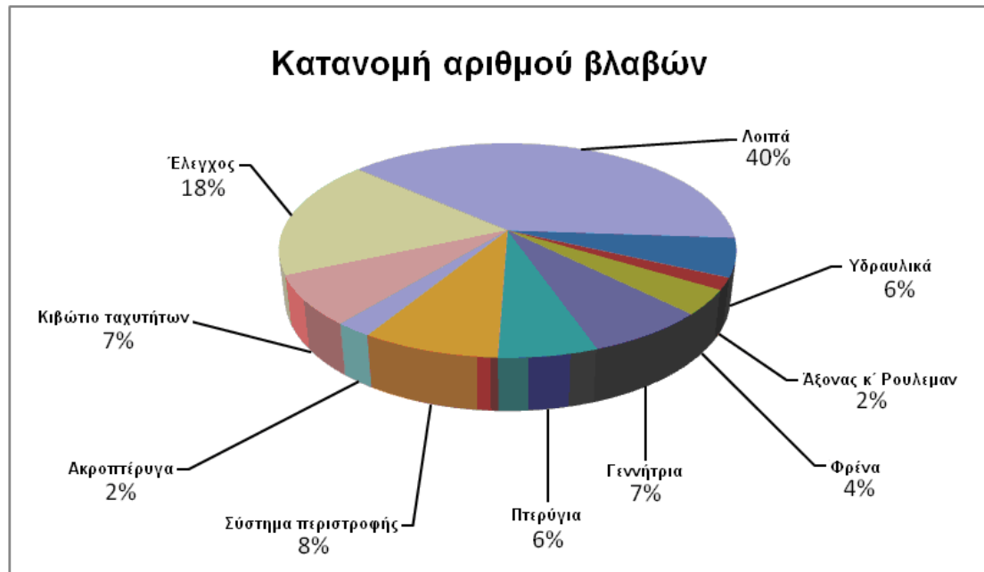
Σχήμα 4.15: Κατανομή ποσοστού μηχανικών βλαβών σύμφωνα με τη βάση δεδομένων 'WindStats' για την περίοδο 1999 - 2001, γράφημα βασισμένο στην αναφορά [33]
