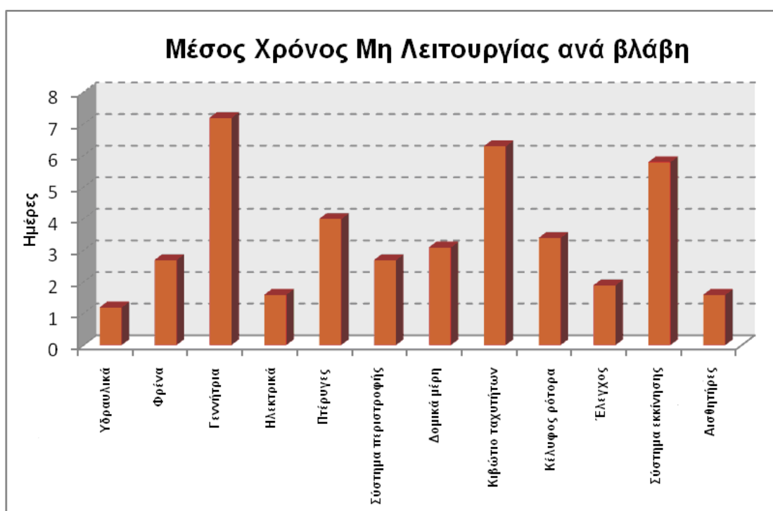
Σχήμα 4.20: Χρόνος μη λειτουργίας ανά βλάβη για κάθε εξάρτημα, γράφημα βασισμένο στην αναφορά [34]
