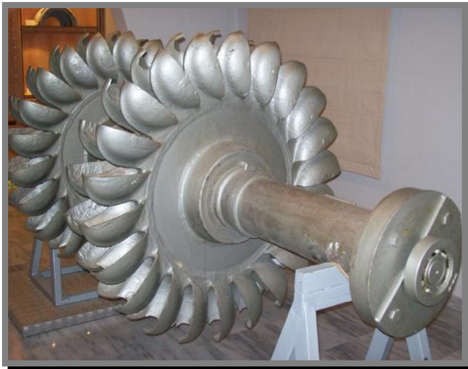
Εικόνα 52: Παλιός Τροχός Pelton με συγκολλημένα σκαφίδια
