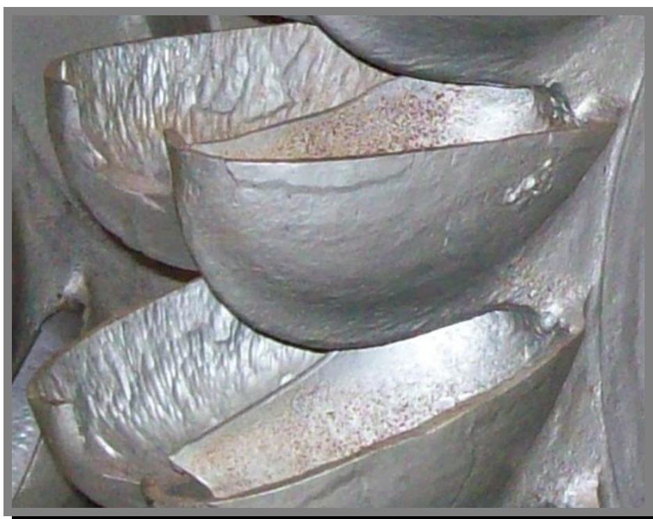
Εικόνα 54: Φθορά Επιφάνειας Σκαφιδίου
