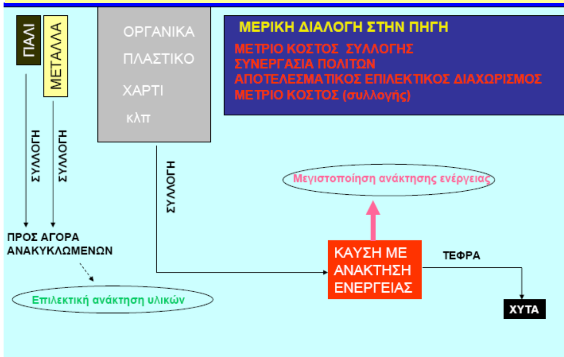
Σχήμα 6: Αξιοποίηση απορριμμάτων για ανάκτηση ενέργειας
