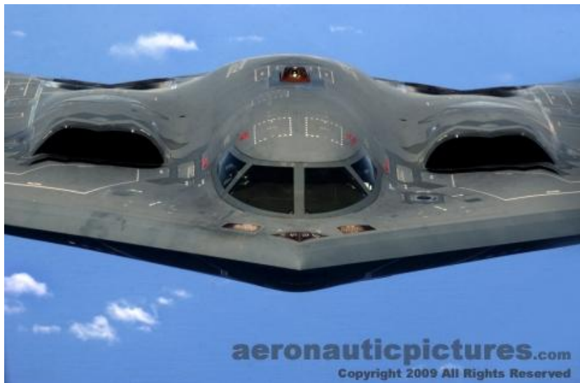
Εικόνα 6.6 : Κοντινή άποψη του αεροσκάφους όπου διακρίνεται το μεγάλο αλεξινέμιο, οι εισαγωγές αέρα των κινητήρων και η θυρίδα της υποδοχής του βραχίονα για εναέριο ανεφοδιασμό καυσίμου.
