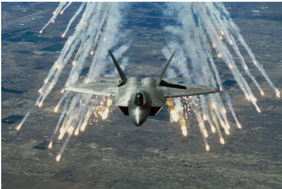
Εικόνα 6.16 : Ένα FA-22 πραγματοποιεί δοκιμές του συστήματος αυτοπροστασίας αφήνοντας μια ριπή θερμοβολίδων. Οι θερμοβολίδες αναπτύσσουν μεγάλο θερμικό ίχνος για να παραπλανήσουν τους πυραύλους IR που ερευνούν για εστίες θερμότητας, ώστε να χτυπήσουν αυτές αντί για το αεροσκάφος.
