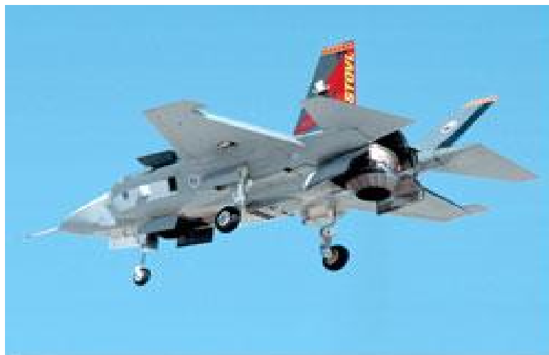
Εικόνα 6.34 : Το X-35B σε αιώρηση. Διακρίνεται το ακροφύσιο σε κατακόρυφη θέση κι ανοικτές όλες οι θυρίδες του ανεμιστήρα ανύψωσης που κανονικά κλείνουν σ' ευθεία πτήση.
