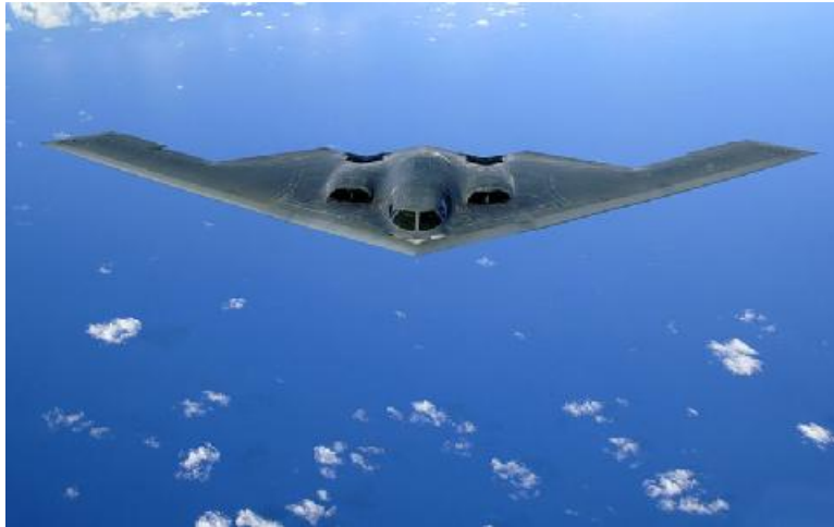
Εικόνα 6.2 : Το B-2 είναι ένα μοναδικό αεροσκάφος με σχήμα ιπτάμενης πτέρυγας.
