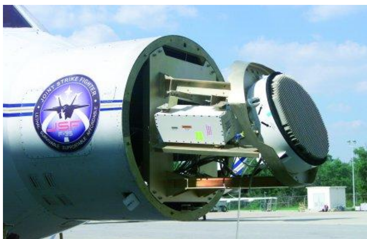
Εικόνα 6.35 : Το ραντάρ APG-81 τεχνολογίας AESA που θα εξοπλίσει το F-35.
