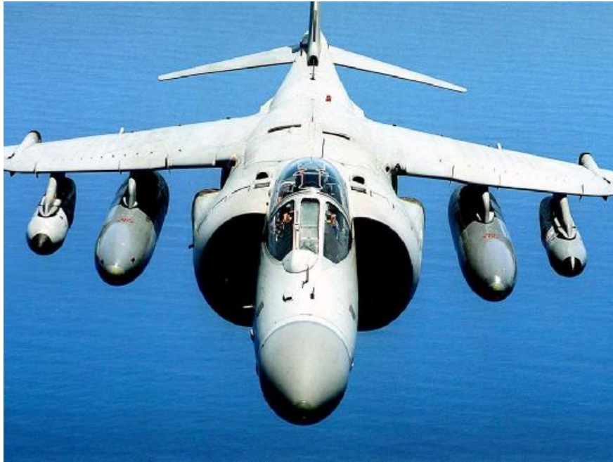
Εικόνα 3.11 : Σ' αυτή την φωτογραφία ενός Sea Harrier διακρίνεται ένα πλήθος κοιλοτήτων, όπως ο κώνος του ραντάρ, η καλύπτρα και οι μεγάλες εισαγωγές αέρα.
