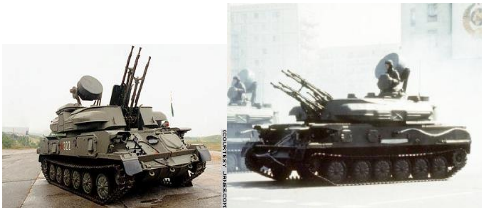
Εικόνες 7.9 : Το αυτοκινούμενο αντιαεροπορικό ZSU-23-4 με 4 πυροβόλα των 23mm.
