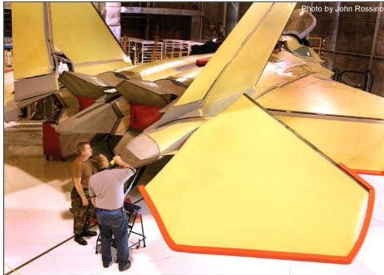
Εικόνα 4.13α : Βάψιμο του FA-22 με ειδικές μπογιές απορρόφησης ακτινοβολίας.
