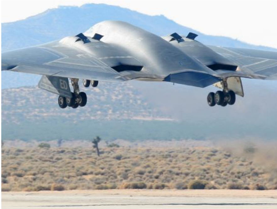
Εικόνα 6.5 : Στην εικόνα αυτή διακρίνονται τ' ακροφύσια χαμηλού θερμικού ίχνους, το "Beaver Tail", τις βοηθητικές θυρίδες των αεροεισαγωγών ανοικτές και τα κύρια σκέλη προσγειώσεως.
