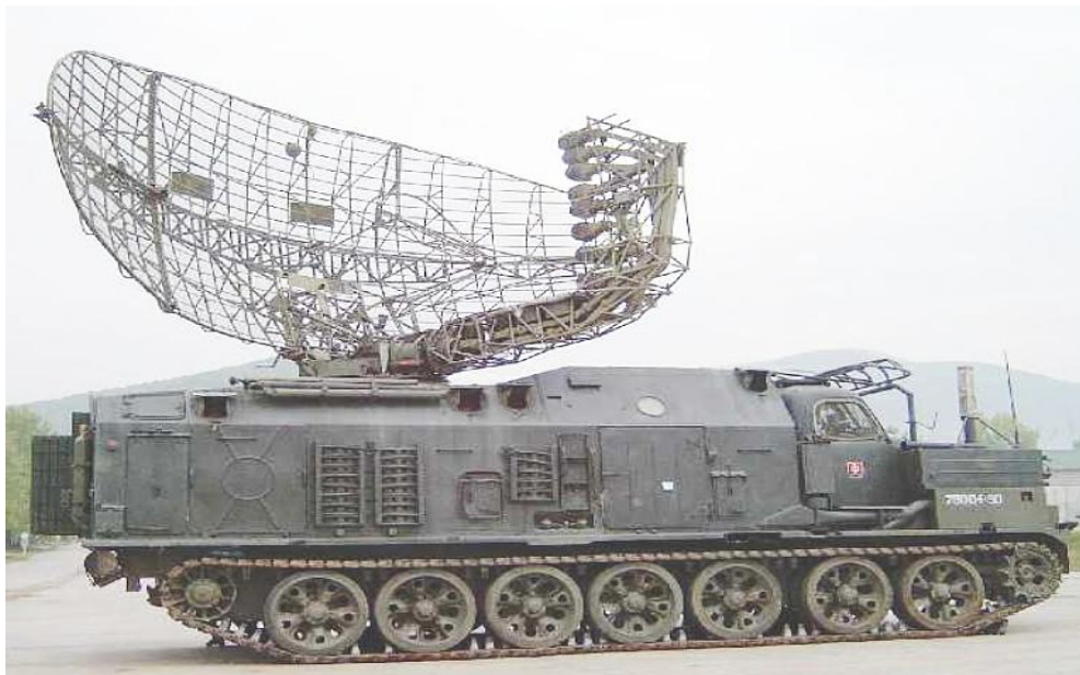
Εικόνα 3.2β : Ραντάρ με περιστρεφόμενη κεραία πάνω σ' ερπυστριοφόρο.
