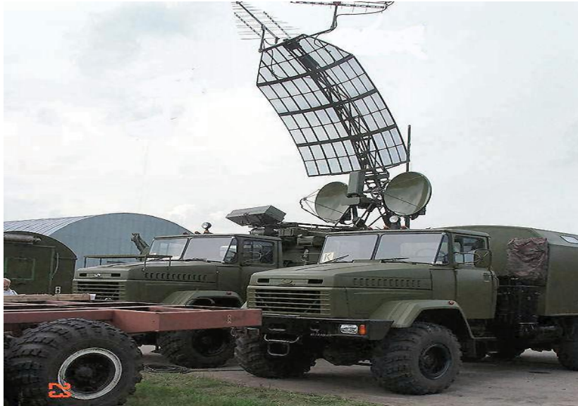
Εικόνα 3.2α : Ένα τυπικό σύστημα ραντάρ με περιστρεφόμενη κεραία. Μία πολύ συνηθισμένη τακτική για την αύξηση της εμβέλειας εντοπισμού είναι η ανύψωση της κεραίας σε μεγάλο ύψος, ώστε να υπάρχει μεγαλύτερο εύρος θέσης προς τον ορίζοντα.
