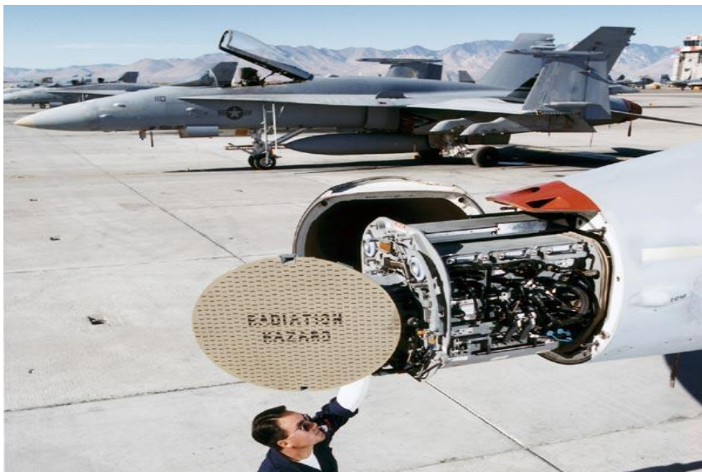
Εικόνα 3.12 : Φωτογραφία του σύγχρονου ραντάρ APG-73 του F-18 πίσω απ' τον διηλεκτρικό κώνο που το κρύβει. Η στάση της κεραίας περιορίζει το R.C.S. όταν δεν λειτουργεί.
