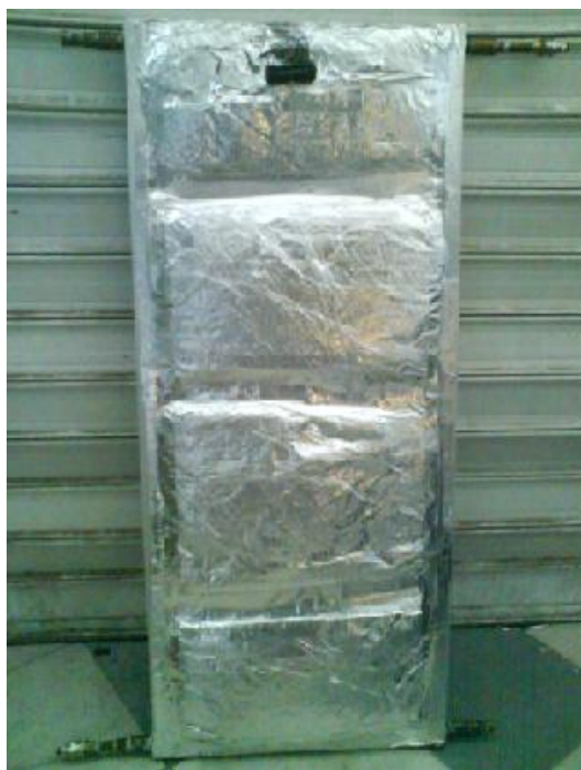
Εικόνα 5.2 : Η πίσω επιφάνεια του PV/T με την μόνωση
