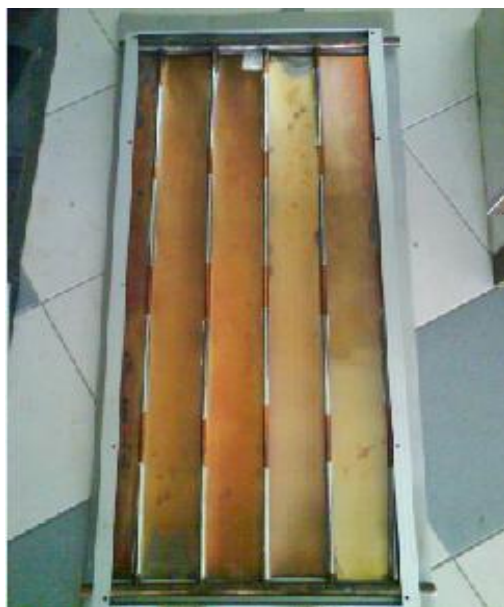
Εικόνα 5.1. Η συλλεκτική επιφάνεια στο πίσω μέρος του PV-T
