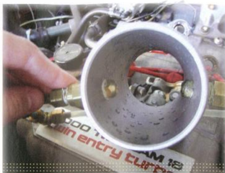
Μια τυπική εγκατάσταση μπει ψεκασμού νερού μέσα στο σωλήνα παραχής συμπιεσμένου αέρα
