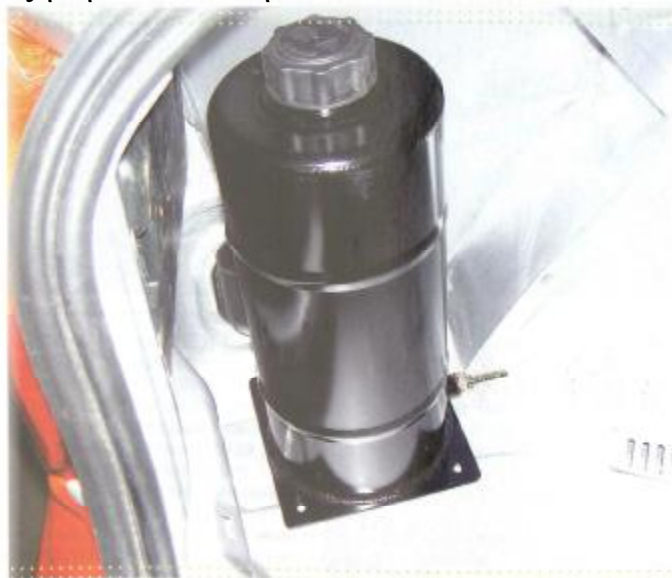
Το water injection μπορεί να χρησιμοποιεί και δικό του αυτόνομο δοχείο, ιδιαίτερα βοηθικό σε περιπτώσεις ανάμιξης με μεθανόλη
