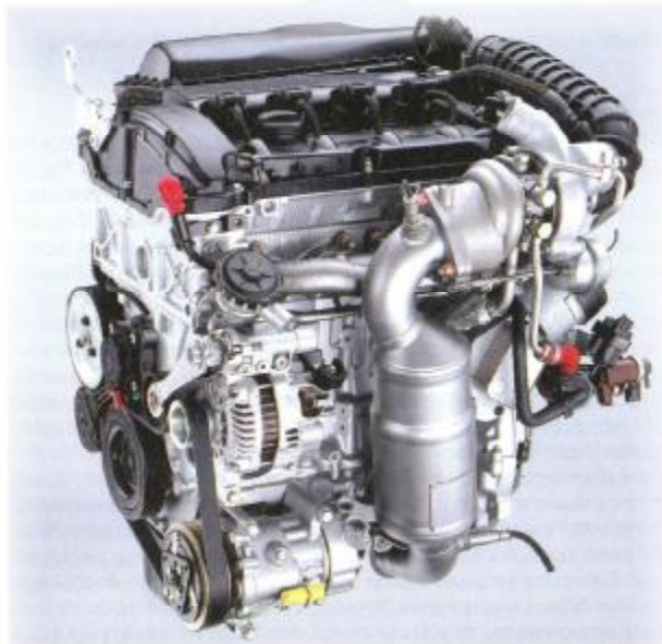
Ο νέος κινητήρας του joint venture BMW Group και PSA που κινεί αυτοκίνητα όπως το Peugeot 207GT και το νέο Mini Cooper 5 έχει σχεδιαστεί με γνώμονα το downsizing, προκειμένου να ελαχιστοποιηθεί το μέγεθός του
