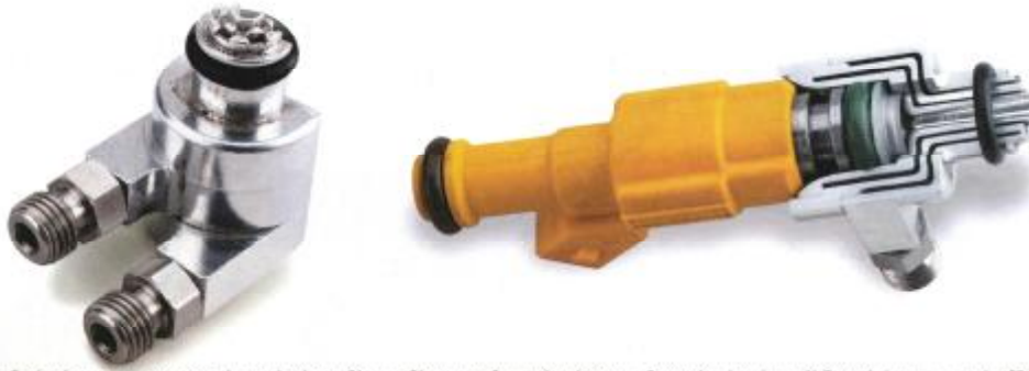
Οι ειδικοί αντάκτορες για τα εργοστασιακά μπεκ είναι ένας απλός, ασφαλής και αποδοτικός τρόπος για να λειτουργήσει ένα σύστημα N_2O υγρού τύπου με φασματικό πολλαπλών σημείων
