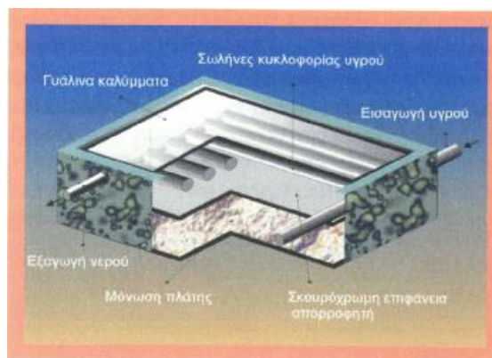
Σχήμα 4.4. Τοπικός ηλιακός συλλέκτης (Πηγή: TRASOL cd-rom).
