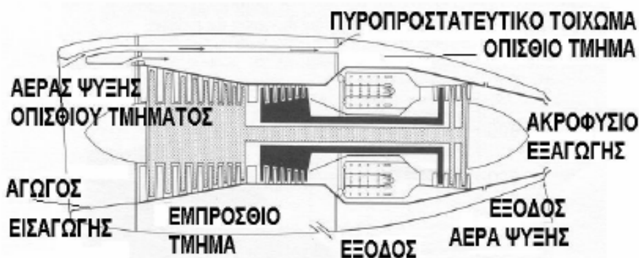
Σχήμα 8.7 Ροή αέρα ψύξης περιβλήματος του κινητήρα
