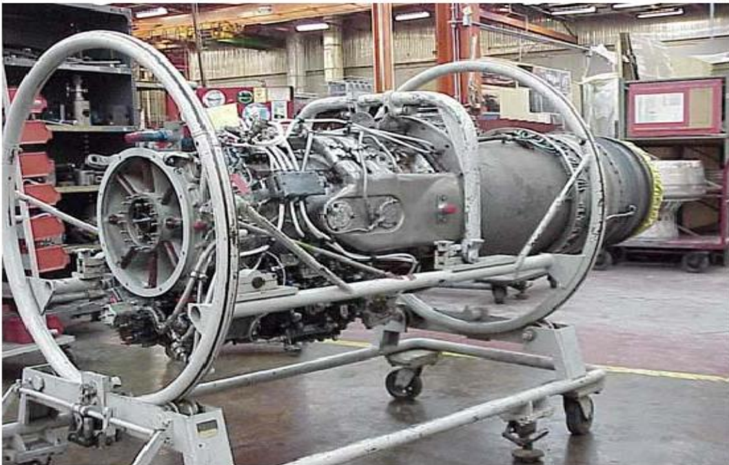
Σχήμα 9.1 Κινητήρας T56 στην οριζόντια κλίση αποσυναρμολόγησης
