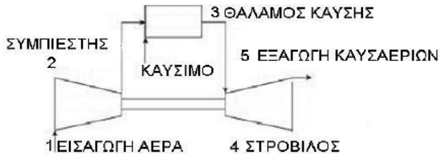
Σχήμα 5.2 Τα μέρη του αεριοστρόβιλου κινητήρα
