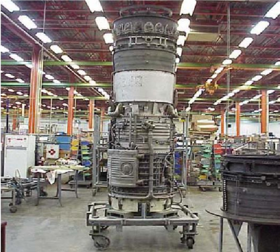
Σχήμα 8.2 Κινητήρας J79 στην κατακόρυφη κλίση αποσυναρμολόγησης
