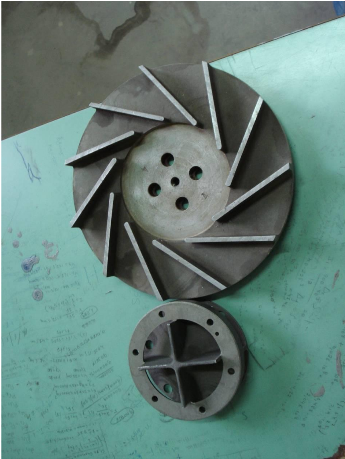
Σχ. 12 Η Νέα Πτερωτή που θα αντικατασταθεί στον σρόβιλο.
