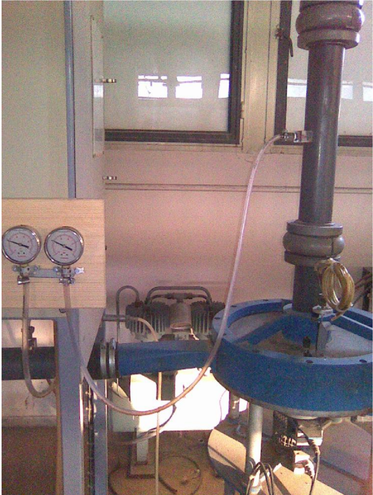
Σχ. 23 Σύνδεση σωλήνα μανομέτρου στον σωλήνα στροβίλου
