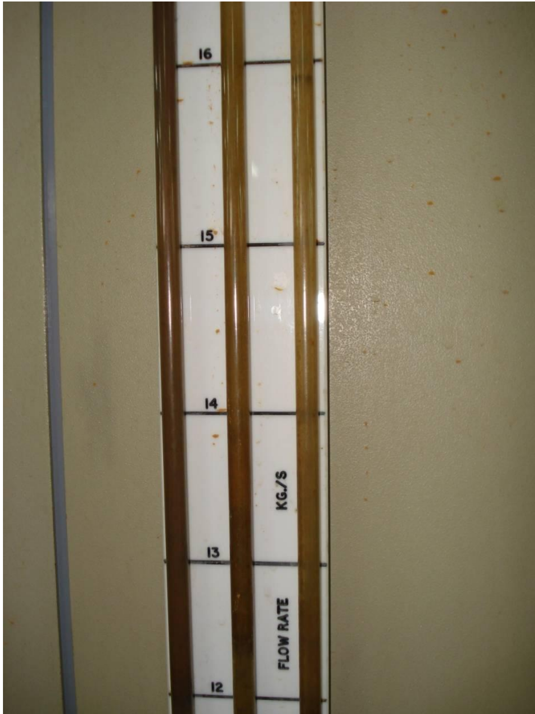
Σχ. 18 Πολυκαιρισμένοι πλαστικοί σωλήνες προς Ventouri
