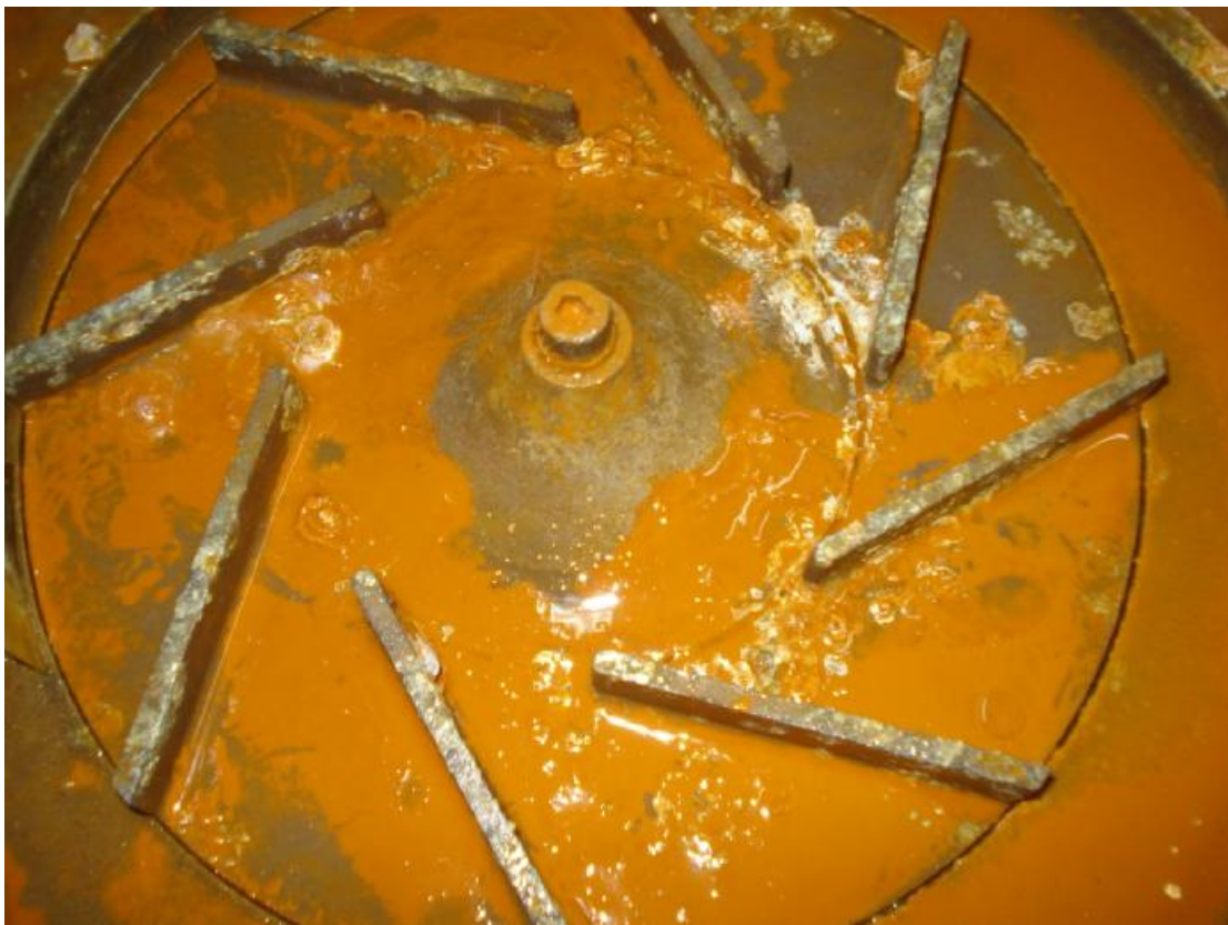
Σχ. 11 Διάβρωση Στροβίλου και παρουσία υδράργυρου
