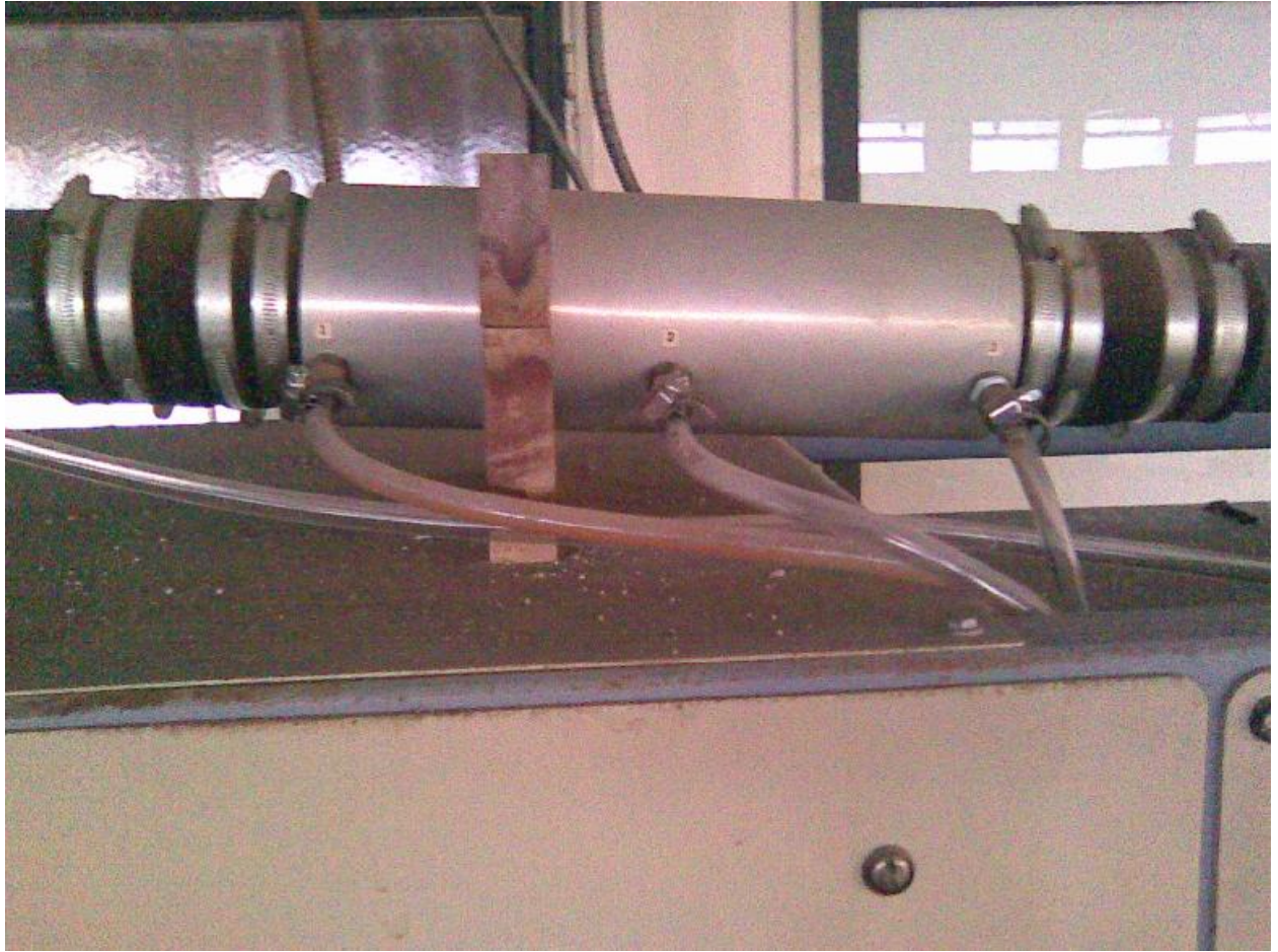
Σχ. 24 Συνδέσεις σωλήνων μανομέτρων με το Ventouri
