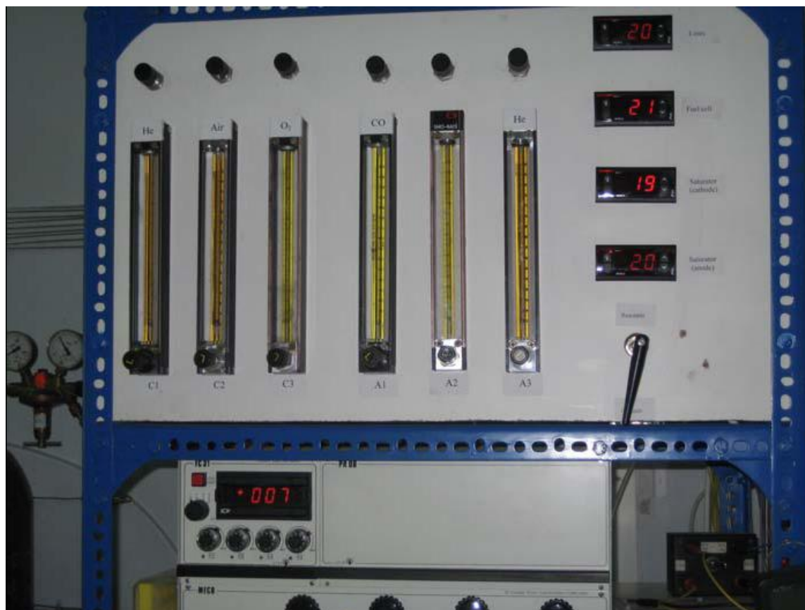
Σχήμα 20: Ρυθμιστές ροής για τη τροφοδοσία της κυψελίδας καυσίμου τύπου PEM
