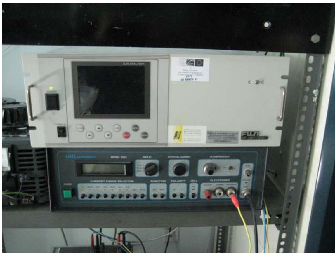
Σχήμα 8: Αναλυτής υπερύθρου μονοξειδίου και διοξειδίου του άνθρακα
