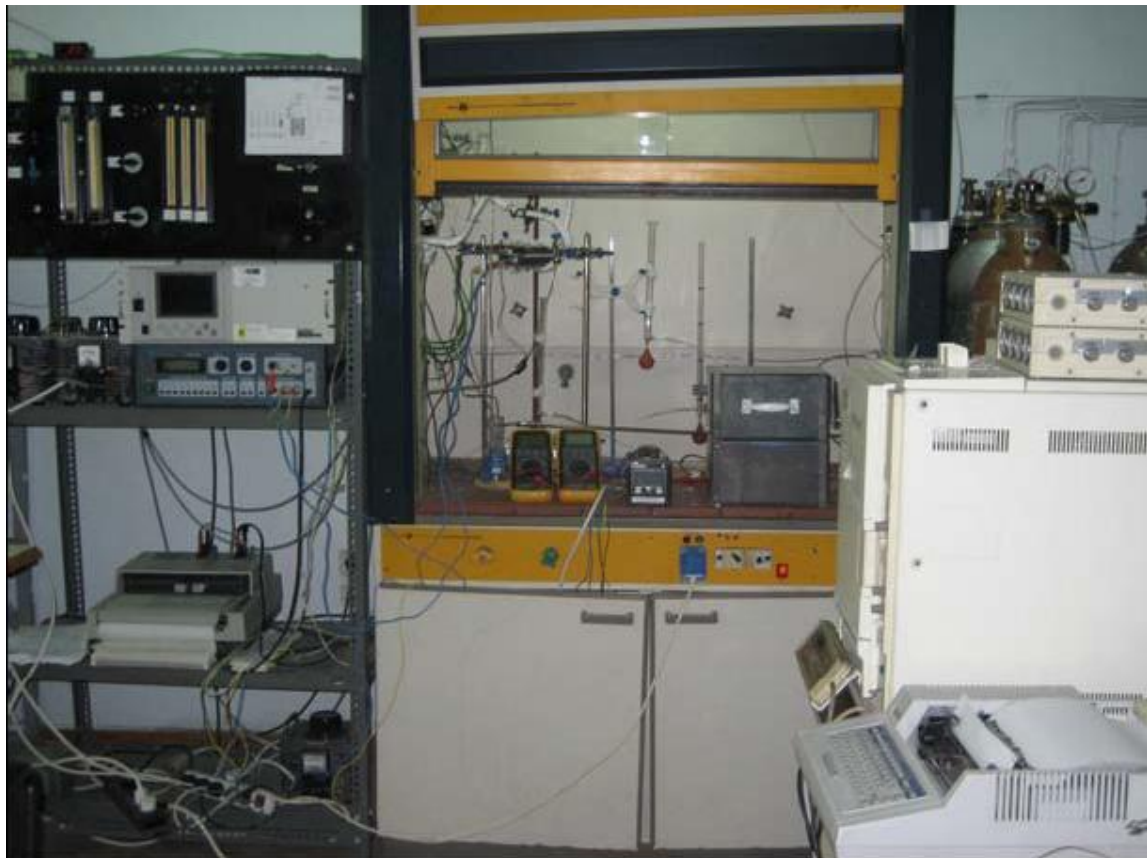
Σχήμα 3: Διάγραμμα πειραματικής διάταξης κυψελίδας καυσίμου μαζί με το σύστημα τροφοδοσίας, καταγραφής σημάτων και ανάλυσης προϊόντων (πάνω). Φωτογραφία της πειραματικής Διάταξης που κατασκευάστηκε στα πλαίσια του προγράμματος (κάτω)
