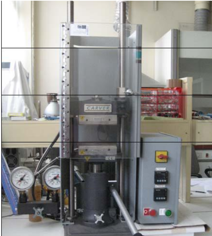
Σχήμα 21: Σύγχρονη θερμοστατούμενη πρέσα με ηλεκτρονικό έλεγχο της θερμοκρασία και δυνατότητα εφαρμογή μικρών και μεγάλων πιέσεων
