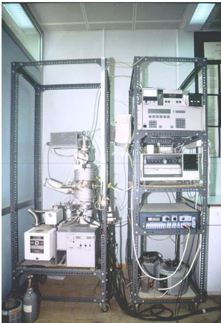
Σχήμα 23: Πειραματική διάταξη για μελέτη ηλεκτροκαταλυτικών συστημάτων με χρήση της τεχνικής της θερμοπρογραμματιζόμενης εκρόφησης σε συνθήκες υπερψηλού κενού.
