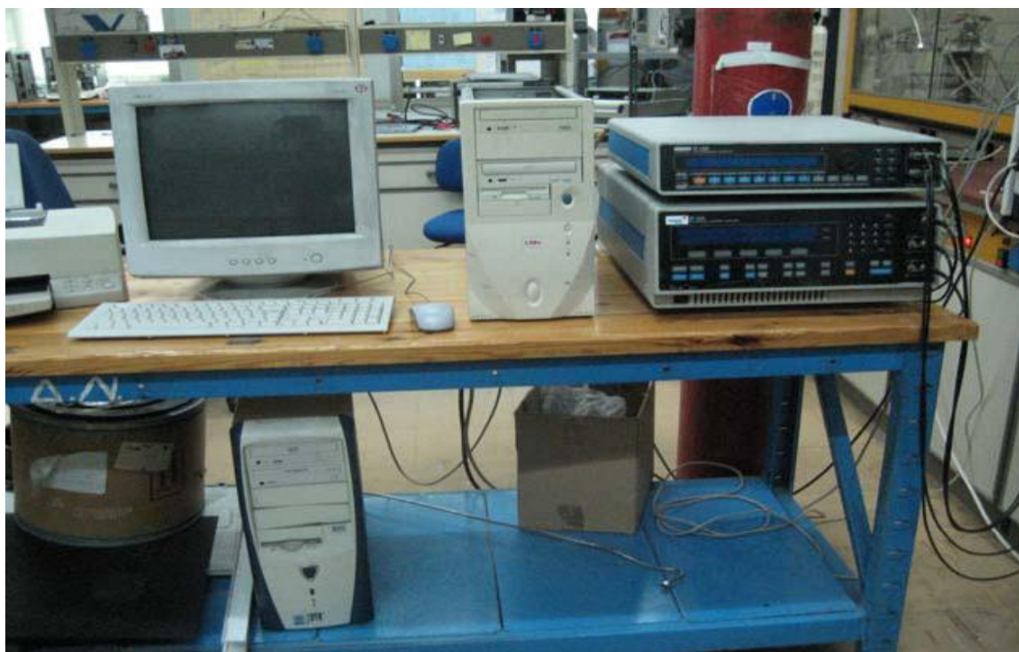
Σχήμα 29: Φωτογραφία από τον εργαστηριακό εξοπλισμό που απαιτείται για τη μελέτη ηλεκτροκαταλυτών με κυκλική βολταμετρία.
