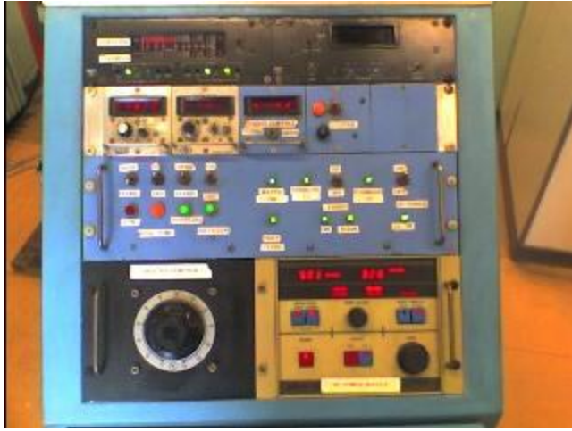
Σχήμα 25: Πειραματική διάταξη εναπόθεσης μεταλλικών ηλεκτροδίων με τη μέθοδο της εξάχνωσης ( sputtering ) σε στερεά υποστρώματα.
