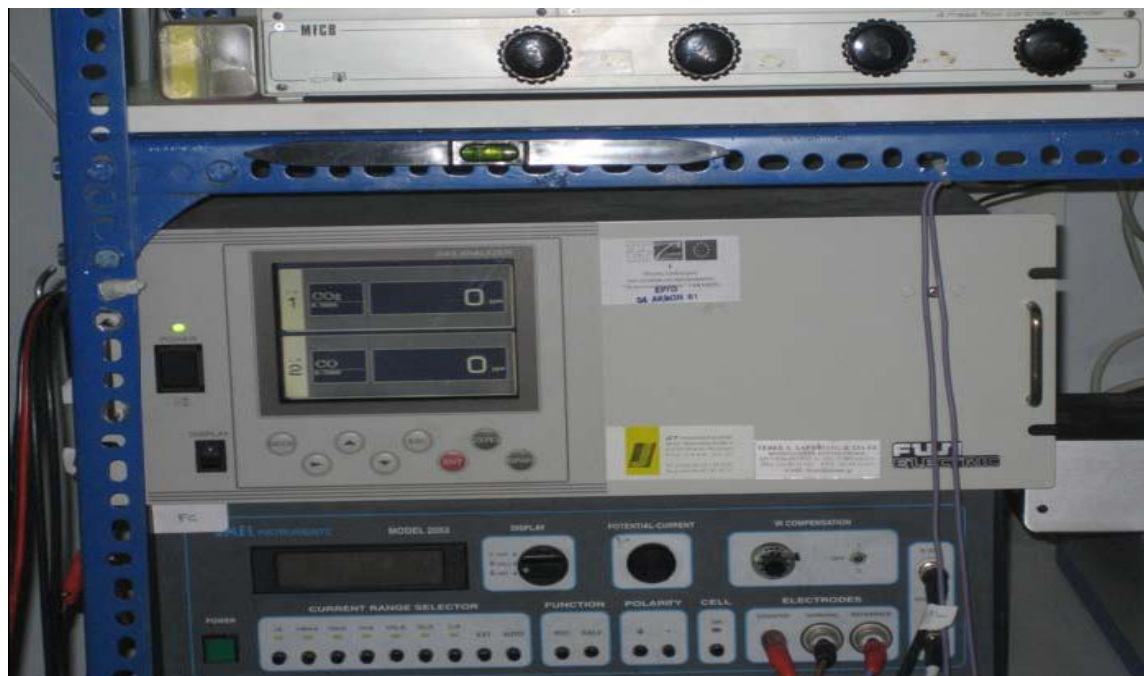
Σχήμα 17: Αναλυτής υπερύθρου μονοξειδίου και διοξειδίου του άνθρακα
