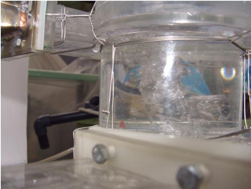
Σχήμα 6.10 Ροή στο κέντρο του διαχωριστή
