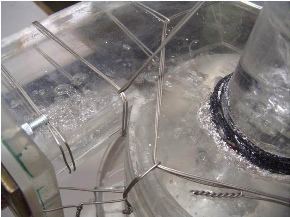
Σχήμα 6.9 Έξοδος μίγματος από τον διαχωριστή
