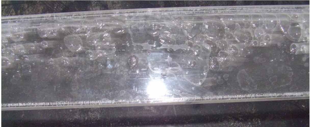
Σχήμα 6.8 Σωλήνα τετράγωνη 38 x 83 με το μίγμα νερού αέρα
