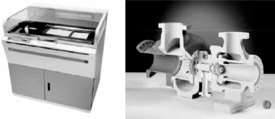
Σχήμα 2.4: Μηχανή ZCorp Z406 και μερικά κομμάτια που δημιουργούνται χρησιμοποιώντας την ικανότητα του χρώματος
