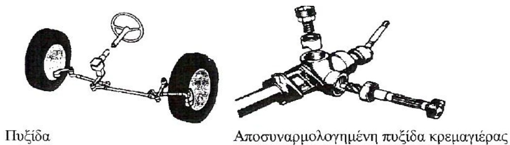
Σχήμα 6.3 : Σχηματική διάταξη του μηχανισμού διεύθυνσης «πυξίδα»
