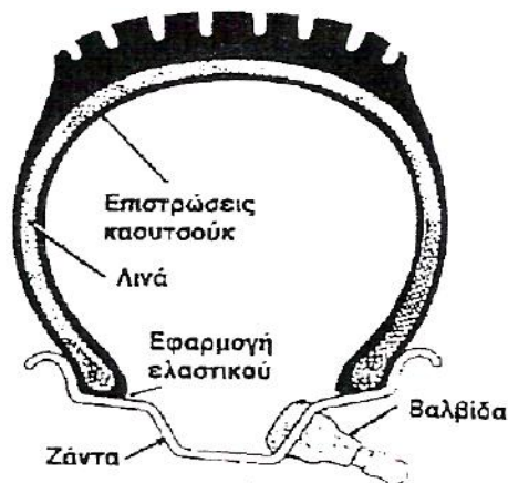
Σχήμα 7.11 : Ελαστικά χωρίς αεροθάλαμο (Tubeless)
