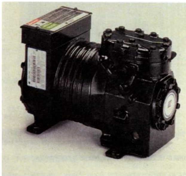
ΕΙΚΟΝΑ 3.11: Αερόψυκτος συμπιεστής. Σημειώστε ότι η γραμμή αναρρόφησης εισέρχεται στην πλευρά που βρίσκεται ο κύλινδρος.
