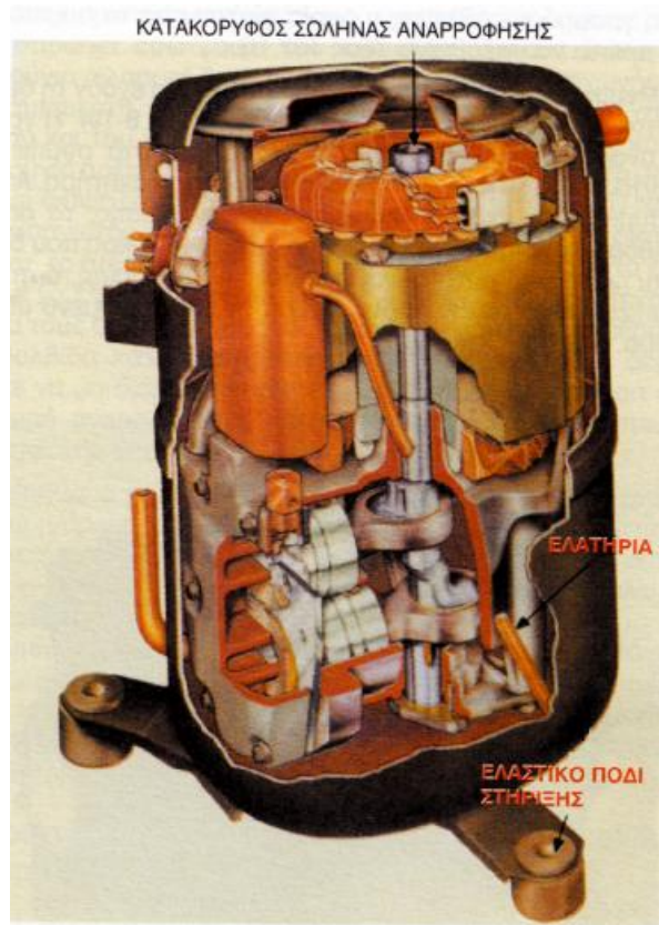
ΕΙΚΟΝΑ 3.9: Συμπιεστής που ψύχεται με το αέριο αναρρόφησης.
