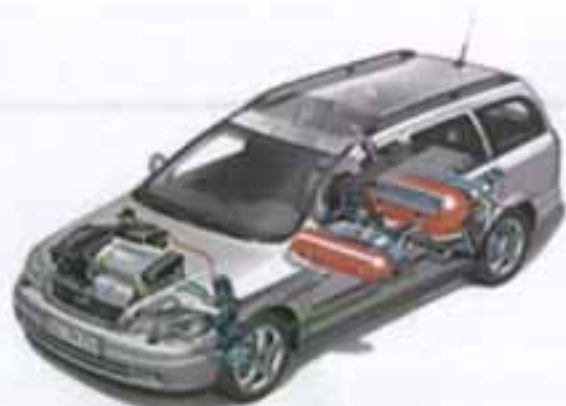
Σχ. 13. Μονοσθενής τεχνολογία της OPEL CNG
