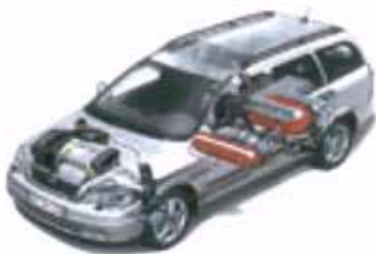
Σχ. 21. Σημείο αποθήκευσης Φ. Αερίου στο OPEL CORSA
