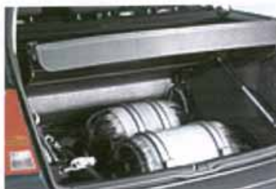
Σχ. 26. Χώρος αποσκευών μετά την τοποθέτηση φιαλών Φ. Αερίου
