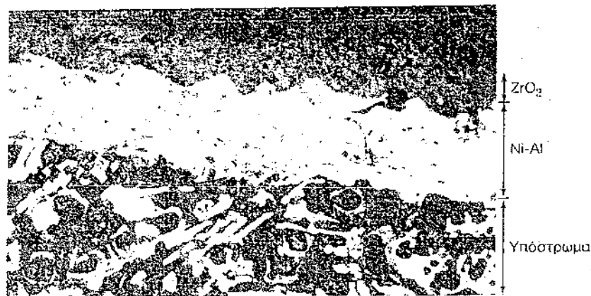
ΗΜΑ III.29. Οπτική μικρογραφία επιστρώματος ψεκασμού ατμοσφαιρικού πλάσματος: Ζιρκονία σε υπόστρωμα χυτοσιδήρου σφαιροειδούς γραφίτη, με ενδιάμεσο συνδετικό στρώμα Ni-Al (x200).
