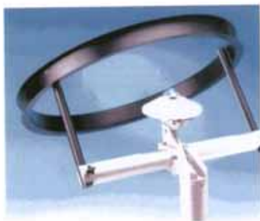
Σχήμα 2.8 Πυρανόμετρο εφοδιασμένο με δαχτυλίδι
