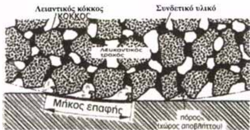
Σχ.22 Υφή και μήκος επαφής του λειαντικού τροχού
