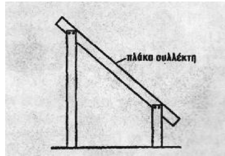
Εικόνα 73: Εγκατάσταση των ηλιακών συλλεκτών σε ξύλινους στύλους, με κλίση 30^{\circ} - 40^{\circ} με πρόσωπο προς τον ήλιο
