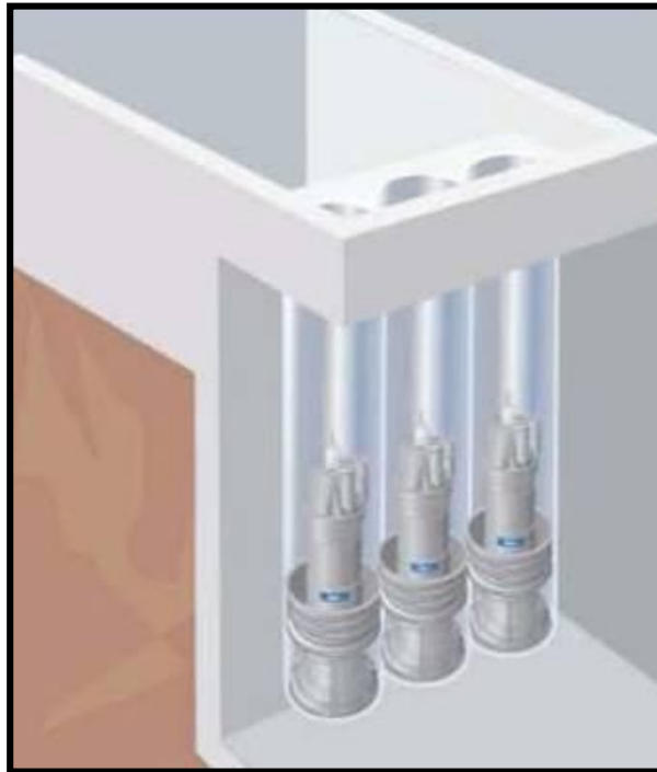
Εικόνα 9.2ε. Εντός κυλινδρικού αγωγού
