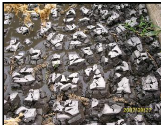
Εικόνα 3.11. Ιλύς σε κλίνες ξήρανσης.
