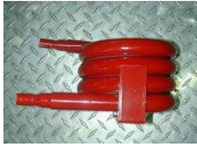
Εικόνα 3.8 Τελικός εναλλάκτης θέρμανσης καυσίμου.
