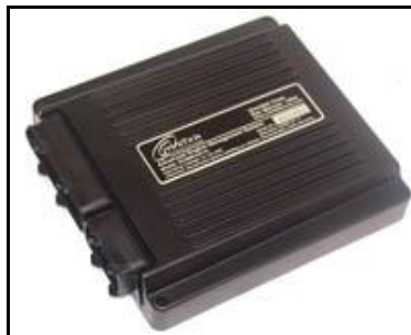
Εικόνα 2.11 Μονάδα ηλεκτρονικού ελέγχου (ECU).
