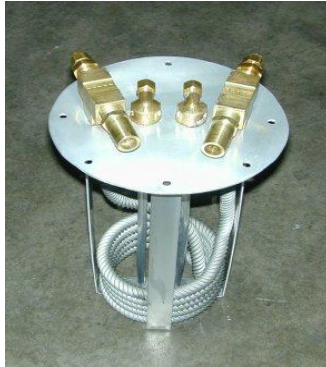
Εικόνα 3.6 Εναλλάκτης θερμότητας εντός της δεξαμενής.
